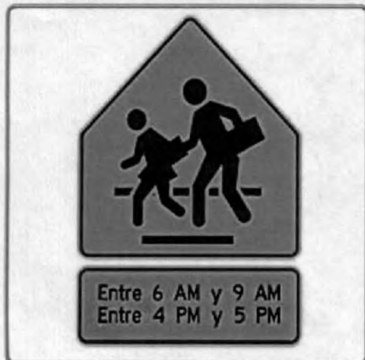
Figura 3-38 Señal con Horario de Mayor Precaución
