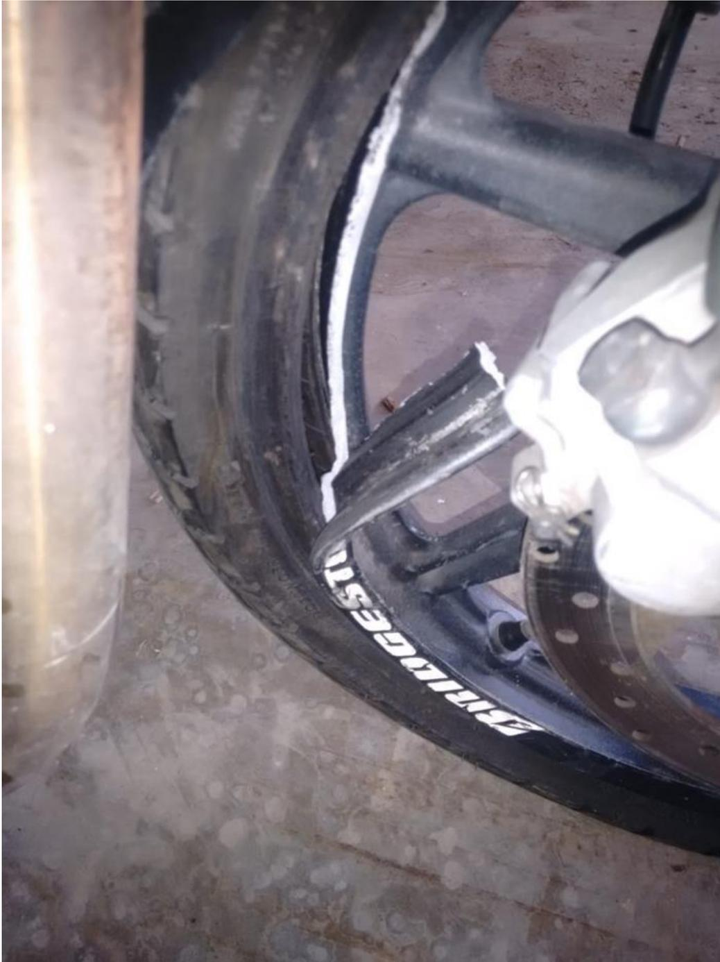
**FOTOGRAFÍA No. 11 PRIMER PLANO:** En esta fotografía se observa la rotura del rin anterior.
