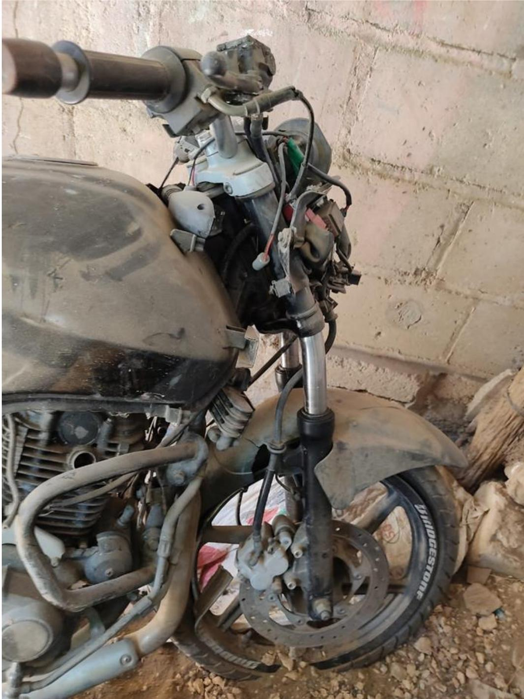
**FOTOGRAFÍA No. 10 PLANO MEDIO:** En esta fotografía se aprecian los daños que afectan el eje anterior, la unidad de luz, el carenaje y el rin.
