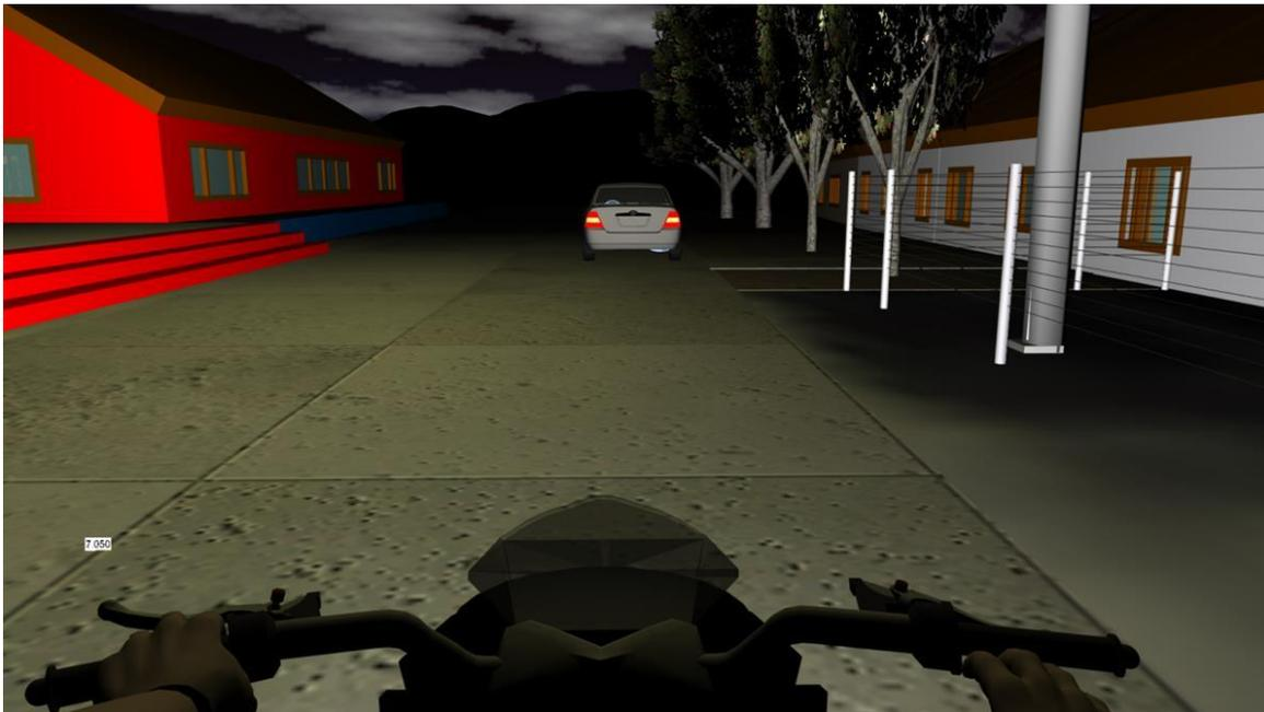
**IMAGEN No. 21:** En estas imágenes en 3D se aprecia la ubicación y visibilidad de la motocicleta 2 s y 1 s antes del impacto si su velocidad es constante, nótese la ubicación del automóvil y la visibilidad.
