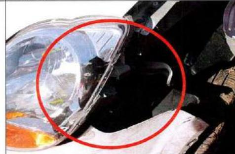
Imagen 4, vista parte frontal tercio izquierdo, se observa farola fracturada en su punto de sujeción.
