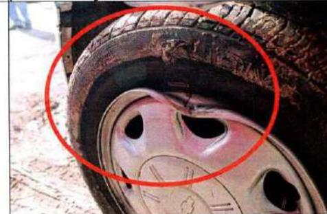
Imagen 6, vista parte lateral izquierdo tercio anterior, se observa rin con deformación en la pestaña, llanta perforada en la banda lateral.
