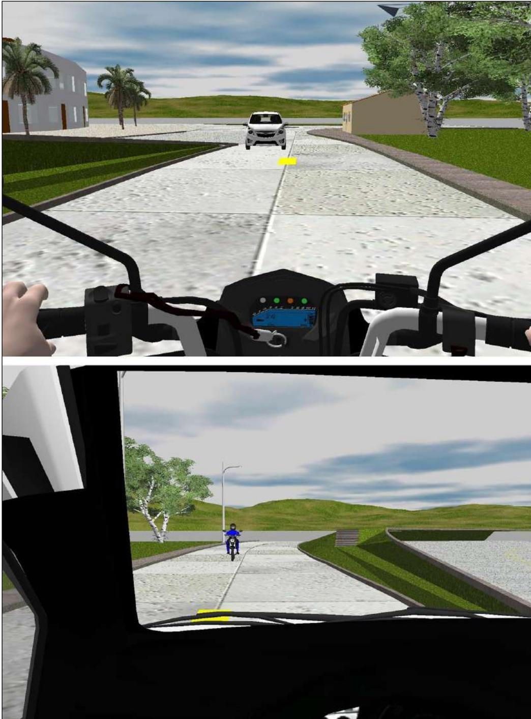
**Imagen No. 39:** En esta imagen se observa la visibilidad que tenían los conductores de los vehículos 1,35 s antes del impacto si sus velocidades son constantes.
