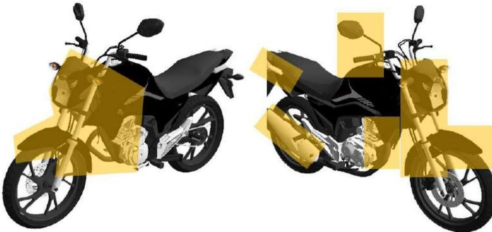
**Imagen No. 12:** En esta imagen basada en los reportes se resalta la zona de daños y evidencias en el rodante. Elaboración en el software Trimble Forensic Reveal.
