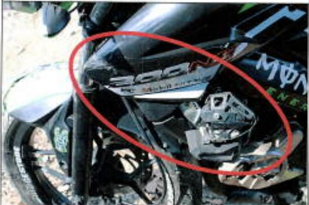
Imagen 9, se observan la carcasa externa del tanque de combustible inferior, caucho de la defensa y luz auxiliar lado izquierdo abollados y rayados por rozamiento.
