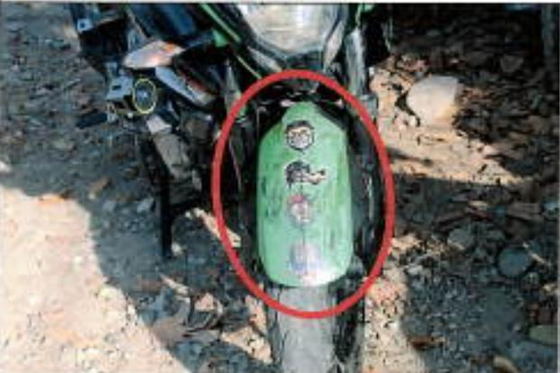
Imagen 5, se observa el guarda fango delantero destruido.
