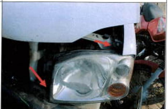
Imagen 10, se observa las bases de sujeción del conjunto de farola lado izquierdo destruidas.
