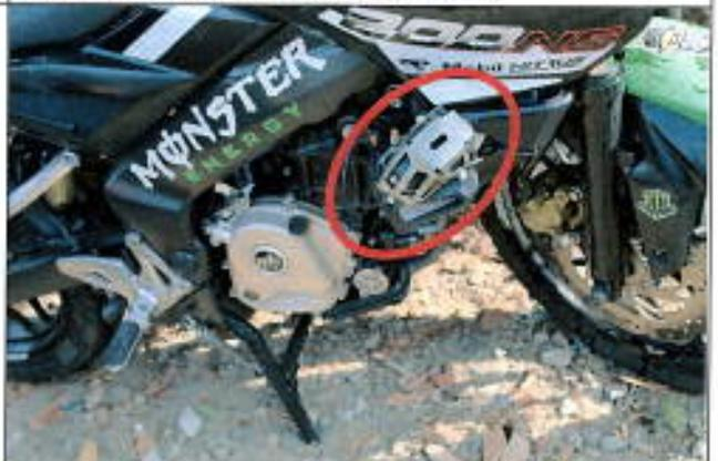
Imagen 16, se observa el luz auxiliar lado derecho desgrafada.
