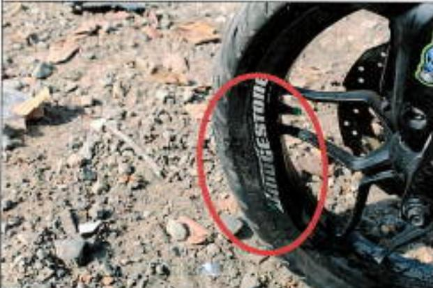
Imagen 3, se observa el rin de la rueda delantera destruido.
