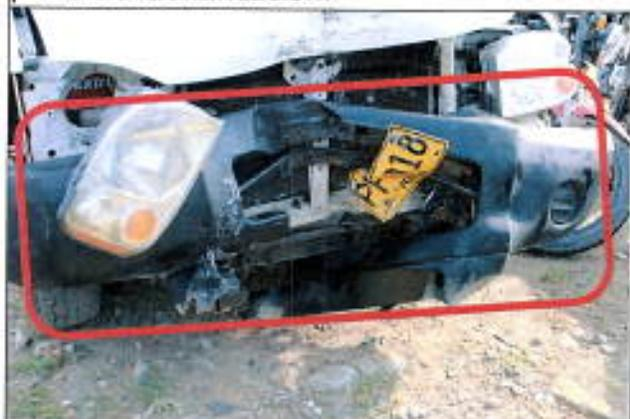
Imagen 3, se observa el bumper delantero destruido.
