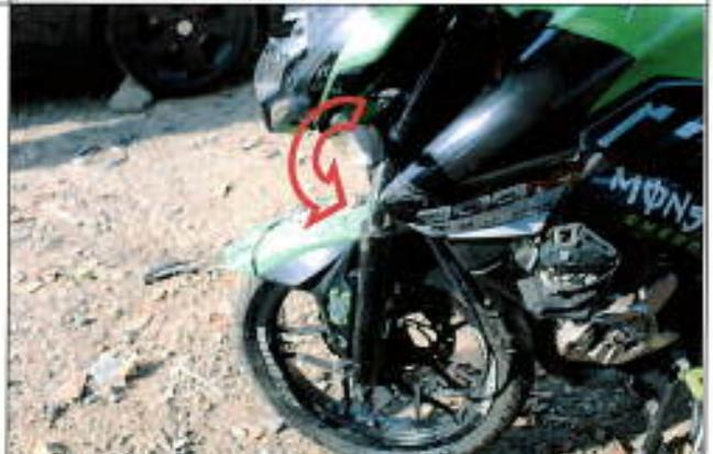
Imagen 4, se observan las barras telescópicas torcidas hacia atrás y giradas hacia la izquierda.
