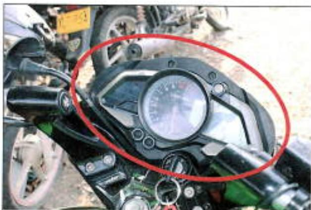
Imagen 7, se observa el tacómetro de velocidades destruido.
