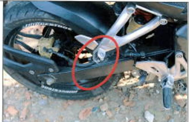
Imagen 14, se observa el descansa pie trasero lado derecho destruido.
