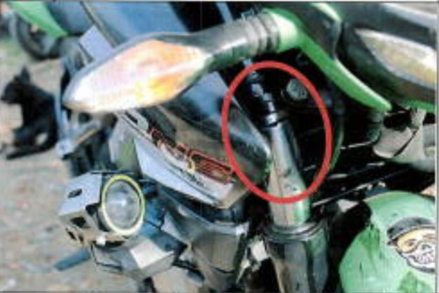
Imagen 17, se observa la barra telescópica derecha destruida.
