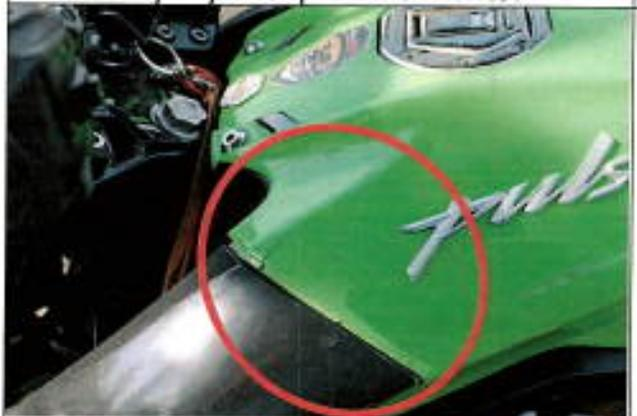
Imagen 11, se observa la carcasa externa del tanque de combustible lado izquierdo superior fisurada y desgrafada del punto de ajuste.
