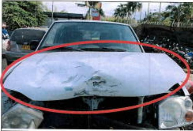
Imagen 7, se observa el capo destruido con transferencia de material sintético de color negro.
