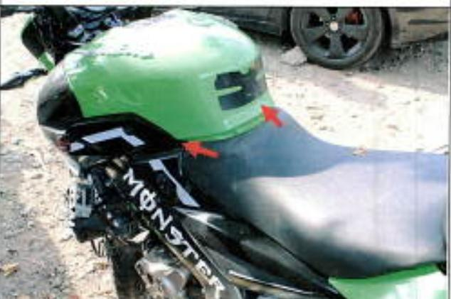
Imagen 12, se observa el tanque de combustible desplazado levemente hacia adelante.
