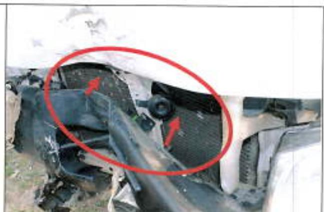
Imagen 8, se observa el radiador destruido con desplazamiento hacia atrás.
