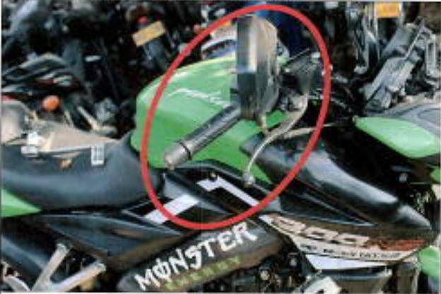
Imagen 15, se observan la manigueta, puntera del timón y cara anterior del espejo retrovisor lado derecho rayados por derrape.
