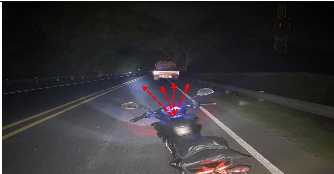
Imagen fotográfica tomada el 09/04/2021, en la cual desde una motocicleta ubicada a 30 metros del **IMPLICADO N°1**, se evidencia los ángulos de visión del **IMPLICADO N2**, con los cuales este al percibir el peligro y desplazándose a 30K/h como esta ordenado solo necesitaría 15 metros para detenerse y sin causar un accidente.
