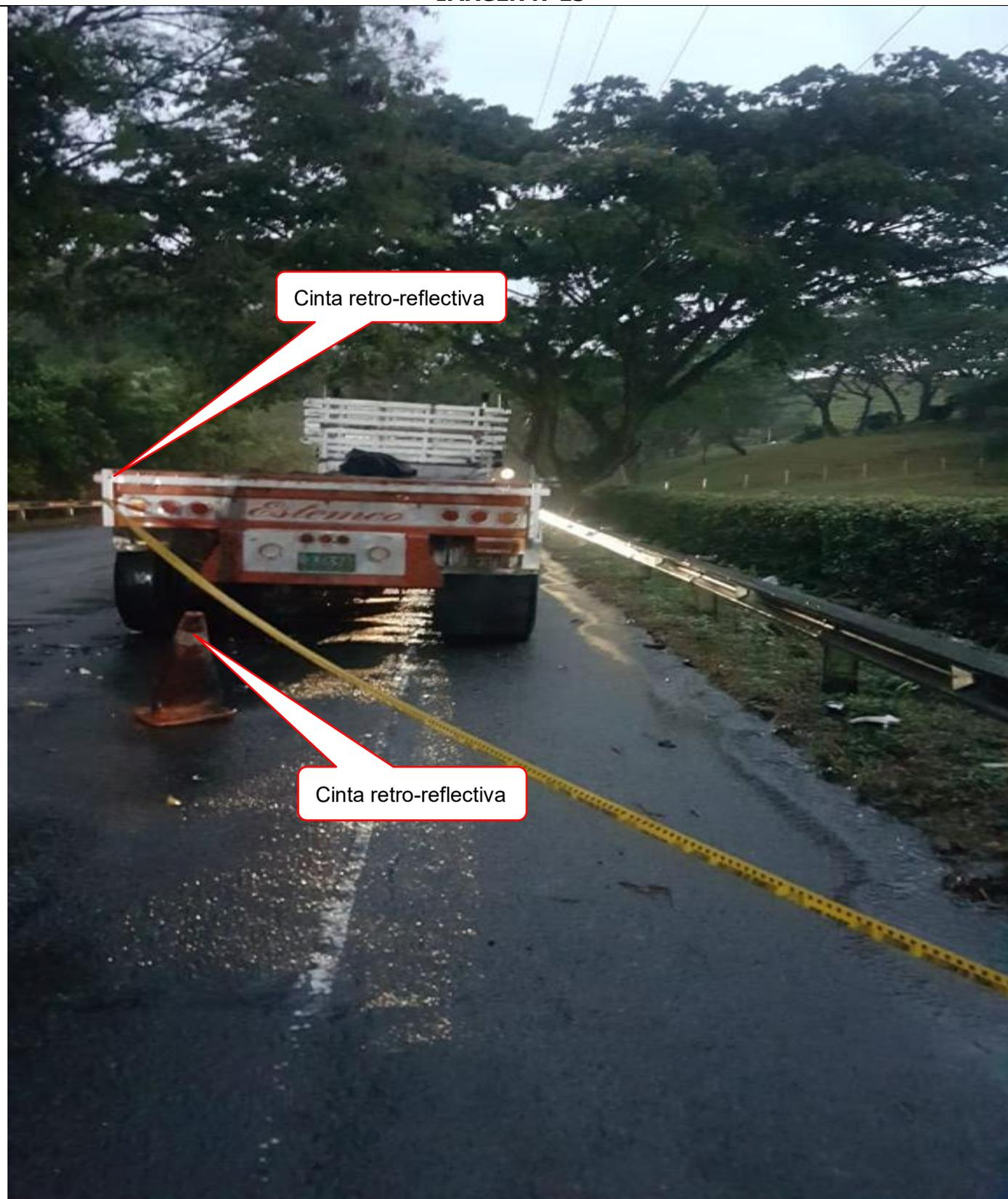
Imagen tomada en los actos urgentes y aportada por la parte interesada, en la cual se ilustra la posición en la cual se encontraba ubicado **EL IMPLICADO N°1** con respecto a la vía de ocurrencia de los hechos, en esta imagen se logra evidenciar que el rodante sobre la zona posterior contaba con la cinta retro-reflectiva y otros elementos los cuales permitían que **EL IMPLICADO N°1** fuera observado sobre la vía.
