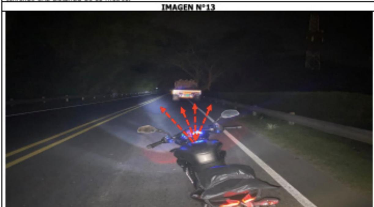
Imagen fotográfica tomada el 09/04/2021, en la cual desde una motocicleta ubicada a 30 metros del **IMPLICADO N°1**, se evidencia los ángulos de visión del **IMPLICADO N2**, con los cuales este al percibir el peligro y desplazándose a 30K/h como esta ordenado solo necesitaría 15 metros para detenerse y sin causar un accidente.
