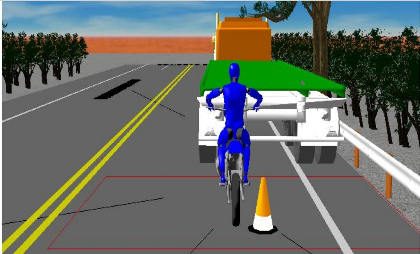
Imagen del reconstructor virtual fx3, en la cual se ilustra la dinámica de trayectoria en que **EL IMPLICADO N°2**, colisiona violentamente al **IMPLICADO N°1** en la zona posterior izquierda, observada desde la trayectoria en que este se desplazaba.
