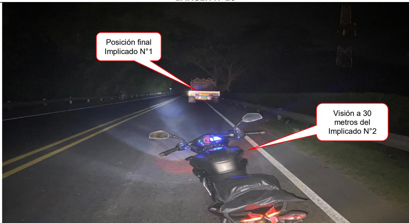
Imagen tomada el 09/04/2021, durante el proceso de análisis e investigación de los hechos, en el cual con la ayuda de una **MOTOCICLETA** y el vehículo tipo **TRACTOCAMION** involucrado en los hechos, se ilustra la visual que tenía a 30 metros **EL IMPLICADO N°2** con respecto al lugar donde se hallaba **EL IMPLICADO N°1**.
