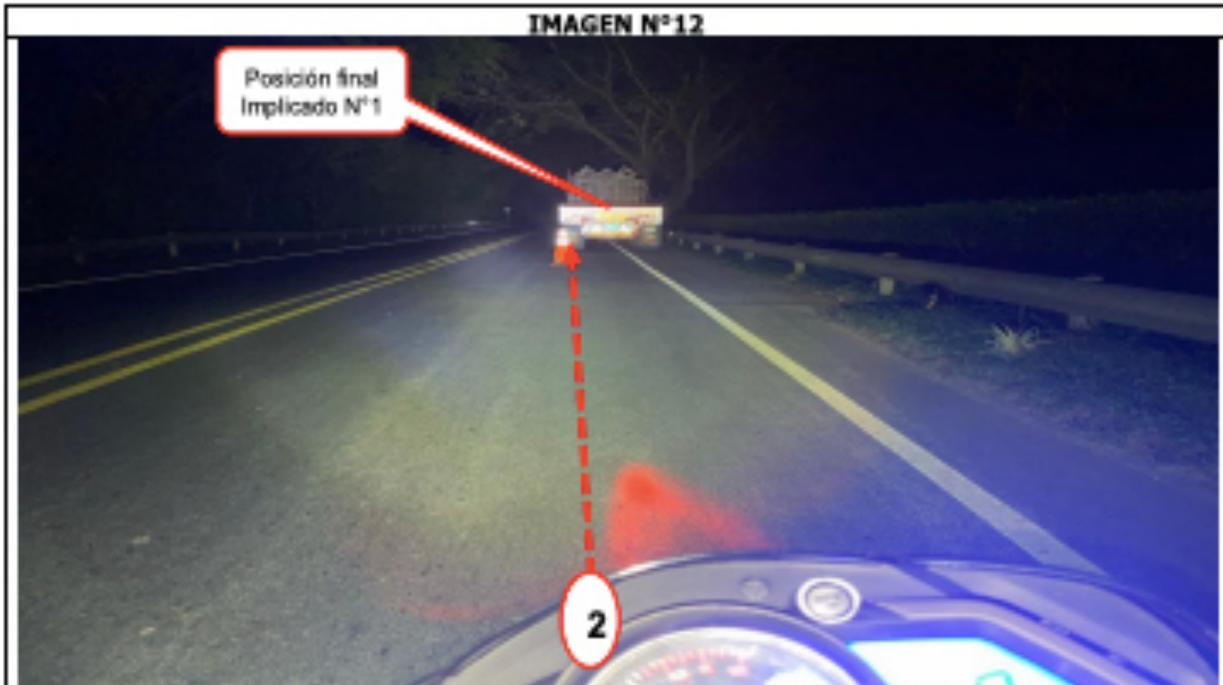
Imagen fotográfica tomada el 09/04/2021, durante el proceso de investigación, en la cual desde una motocicleta ubicada a 30 metros del **IMPLICADO N°1** se logra establecer que **EL IMPLICADO N°2**, para la fecha de los hechos contaba con buena visual, si este fuera transitado con precaución podía detenerse teniendo una distancia de 15 metros.
