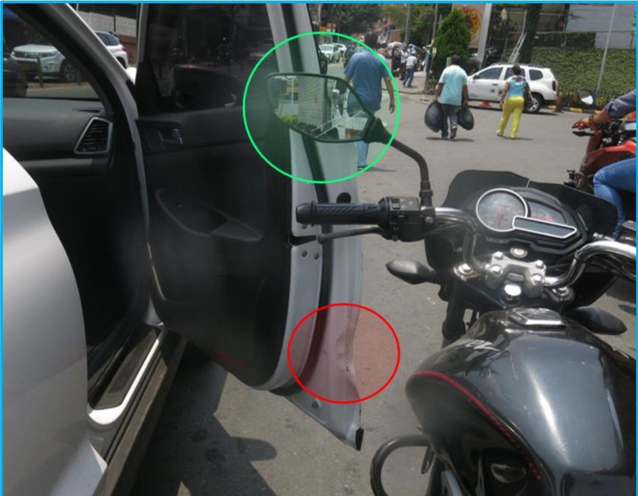
Imagen 8. Lugar de impacto en la camioneta de placa HZS645 Lateral izquierdo. Daños en el borde de la puerta izquierda y transferencia de sangre. (Imagen 05 archivo fotográfico).
