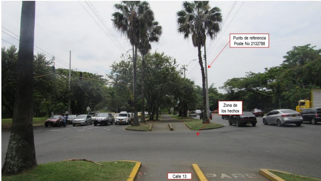
**Fotografía No.9 Plano General** fotografía tomada sentido Sur - Norte, donde se observan las características generales del tramo de vía recta, plana, estado bueno, único sentido de circulación, demarcación horizontal línea de borde blanca y amarilla, separadora de carril segmentada.
