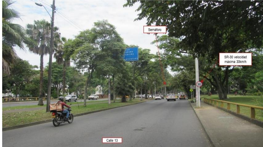
**Fotografía No.3 Plano General:** fotografía tomada sentido Norte - sur, donde se observan las características generales del tramo de vía recta, plana, estado bueno, único sentido de circulación, demarcación horizontal línea de borde blanca y amarilla, separadora de carril segmentada, doble calzada, Señalización vertical SR-30 velocidad máxima 30km/h, semáforo. En este sentido se desplazaban los involucrados.
