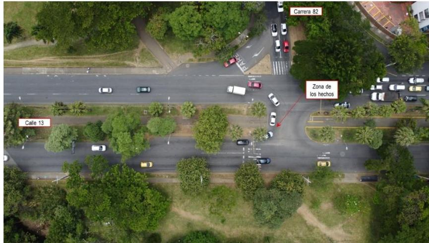
**Fotografía No. 1 Aérea:** fotografía tomada en planta, donde se observan las características generales del tramo de vía recta, plana, estado bueno, único sentido de circulación, doble calzada, demarcación horizontal línea de borde blanca y amarilla, separadora de carril segmentada.
