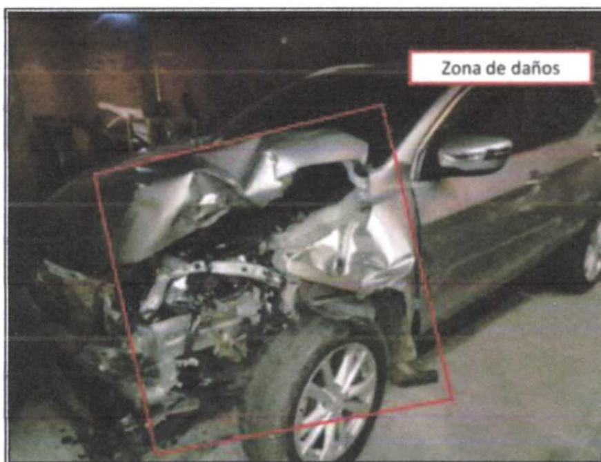
Imagen 3.8 Descripción de daños vehículo 2 (Camioneta)
