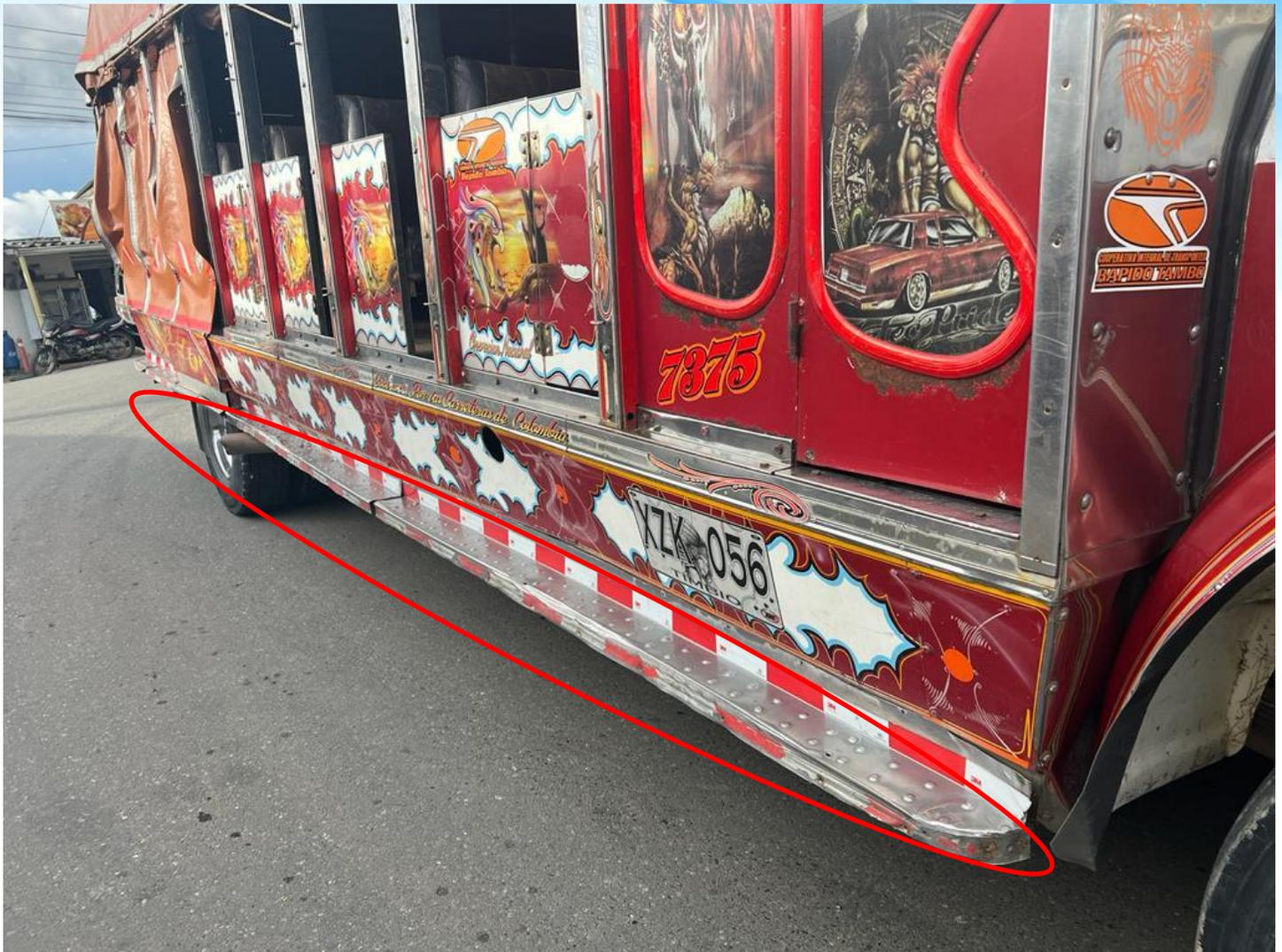
En esta imagen fotográfica tomada desde la parte exterior del vehículo, podemos observar el lado derecho, apreciando el estribo, que cuenta con un buen estado de conservación y funcionamiento, pues este instrumento es de vital importancia para este tipo de vehículo, pues permite el ascenso y descenso de pasajeros del vehículo de una forma correcta, en la misma imagen se evidencia que este vehículo tiene siete (7) sitios de ingreso para los posibles pasajeros.
