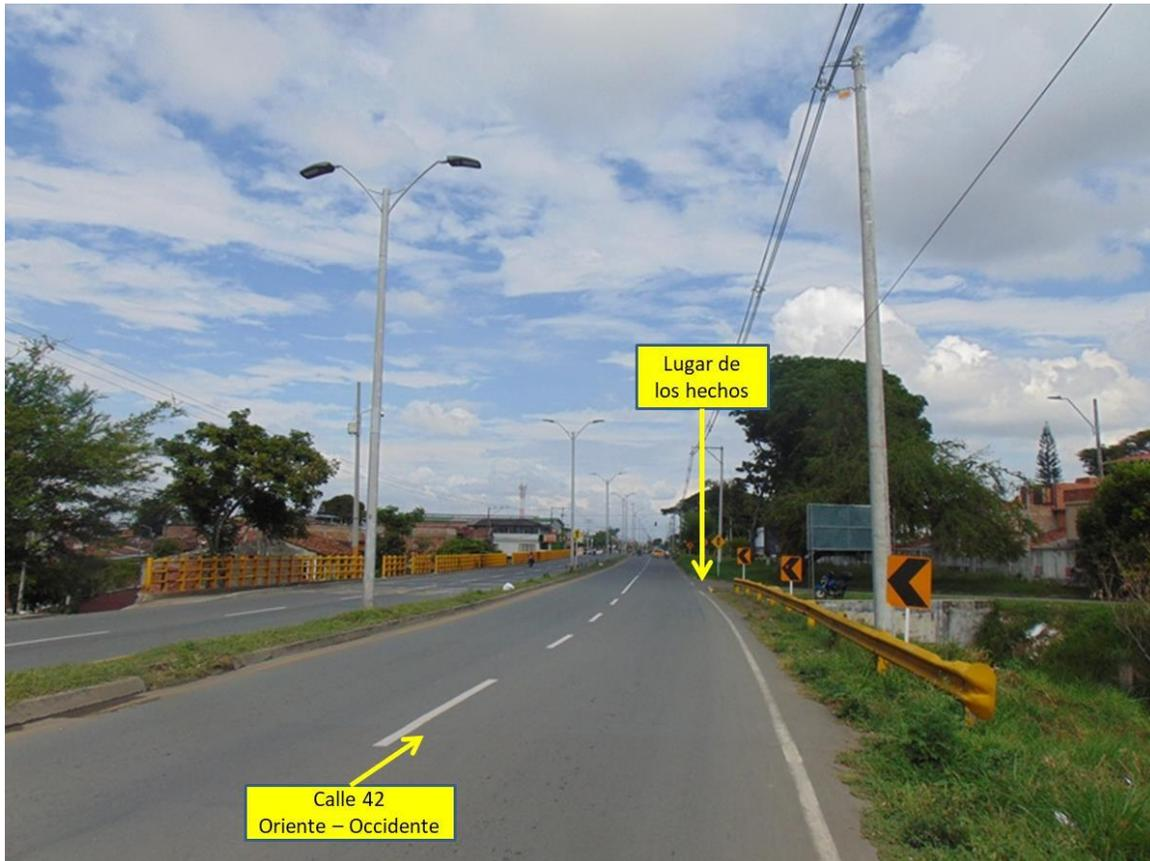
**FOTOGRAFÍA No. 3 PANORÁMICA:** En esta fotografía tomada por el equipo de IRS Vial en sentido oriente – occidente en la calle 42 a la altura de la carrera 4, se aprecian las características generales de la vía en la cual se encuentra demarcación horizontal de línea blanca segmentada y líneas de borde, con señalización vertical delineadores de curva; en este sentido se desplazaban los vehículos.
