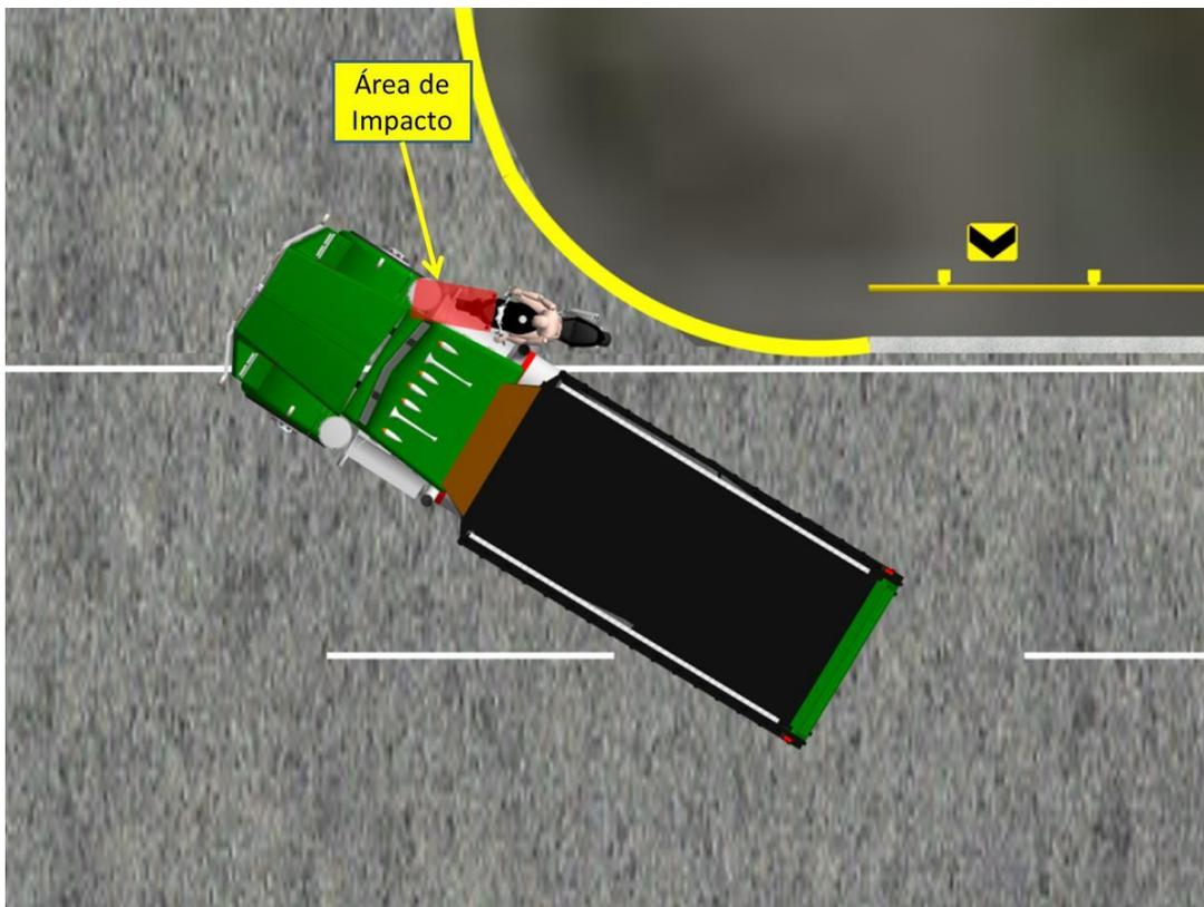
**IMAGEN No. 17:** En esta imagen vista en planta se muestra la posición relativa de los vehículos y el área amarilla de interacción sobre la calzada.
