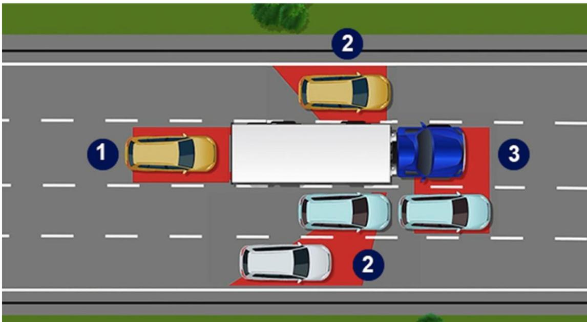
**IMAGEN No. 26:** En esta imagen se aprecia la representación de los puntos ciegos que presenta el conductor de una volqueta, se resalta el punto número 2, el cual se encuentra en sus costados, las cuales pueden ser riesgosas debido al amplio espacio que requieren los operarios para girar.
