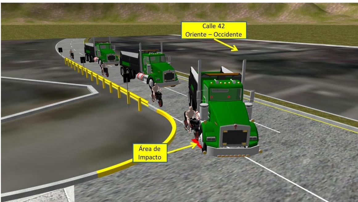
**IMAGEN No. 22:** En estas imágenes, vista en planta y 3D se observa la secuencia del siniestro, nótese el sentido de desplazamiento de los vehículos, así como la posición relativa y el área roja donde se presenta.
