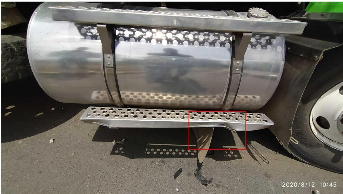
**FOTOGRAFÍA No. 8 PLANO MEDIO:** En estas fotografías se observa el estado final del vehículo, el cual presenta daños en su costado derecho más hacia su tercio medio, afectando el guardafangos y el tanque de combustible.
