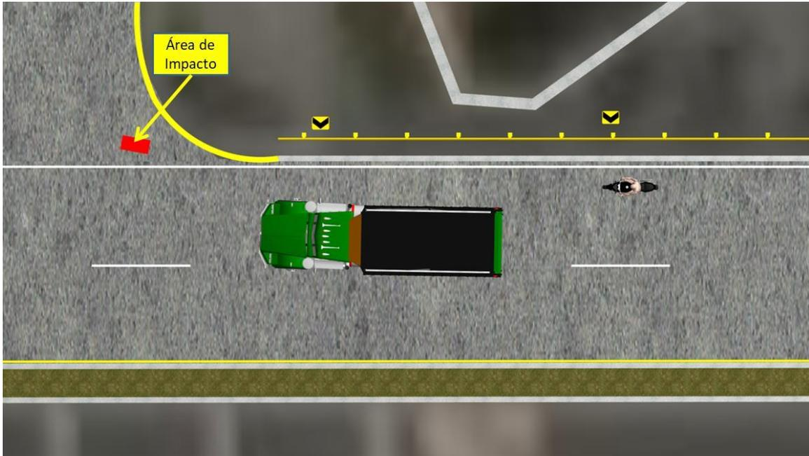
**IMAGEN No. 24:** En esta imagen vista en planta se observa la ubicación de los vehículos 2 s antes del impacto si sus velocidades son constantes.
