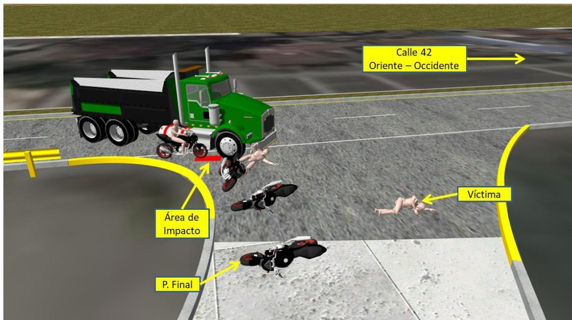
**IMAGEN No. 23:** En estas imágenes, vista en planta y 3D se observa la secuencia del siniestro al momento y después del impacto, así como el desplazamiento hasta sus posiciones finales.
