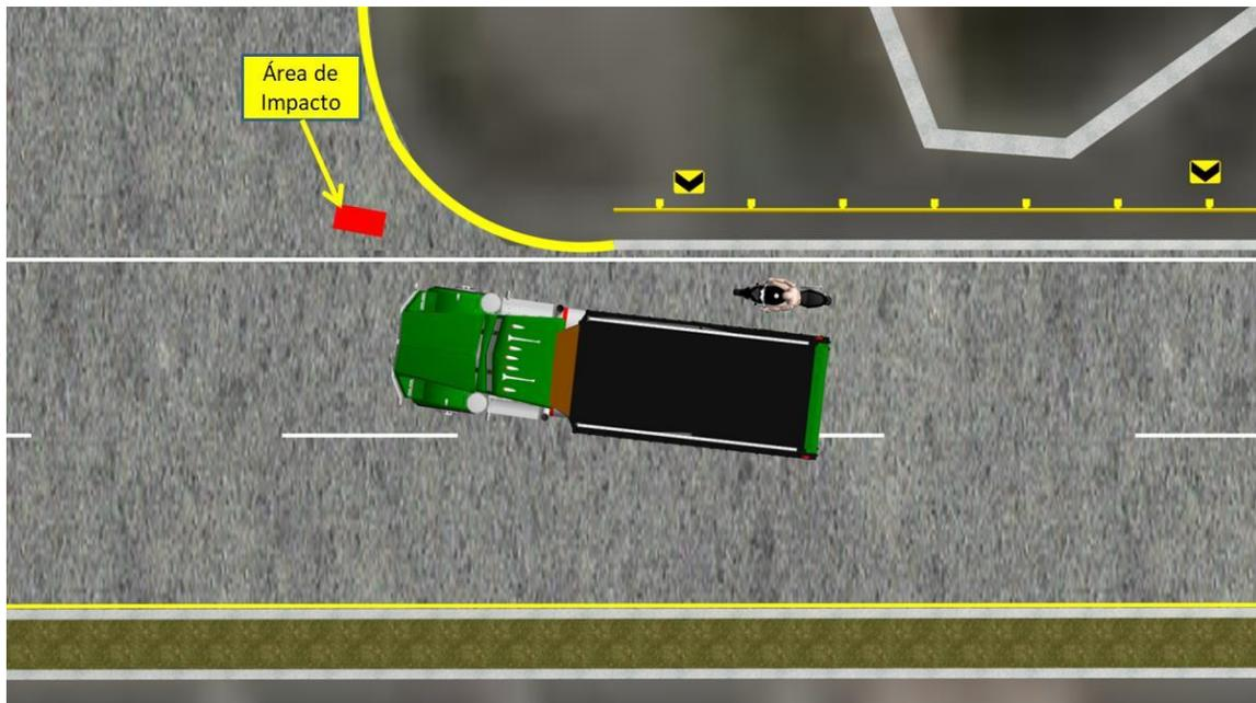
**IMAGEN No. 25:** En esta imagen vista en planta se observa la ubicación de los vehículos 1 s antes del impacto si sus velocidades son constantes.
