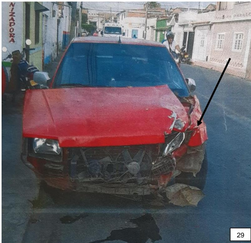
Imagen No. 28 y 29. Fotografía donde se aprecia el fuerte impacto recibido en la parte delantera izquierda en la posición del conductor del vehículo No. 1, que para nuestro caso corresponde al automóvil de placas CAI009.
