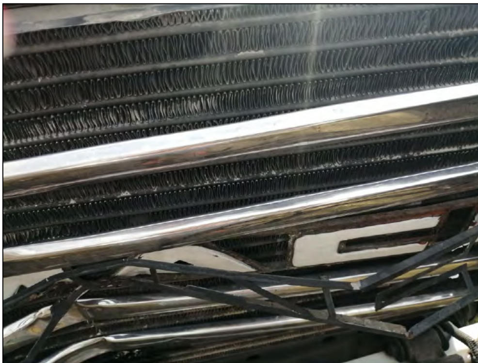
Foto 3 : Registro fotográfico suministrado por el Reclamante. Detalle daño en radiadores.
