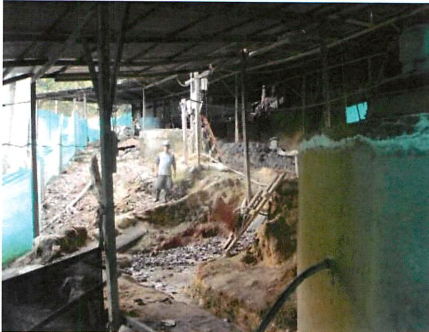
Fotografía 33. Tanque de cianuración y lodos.
