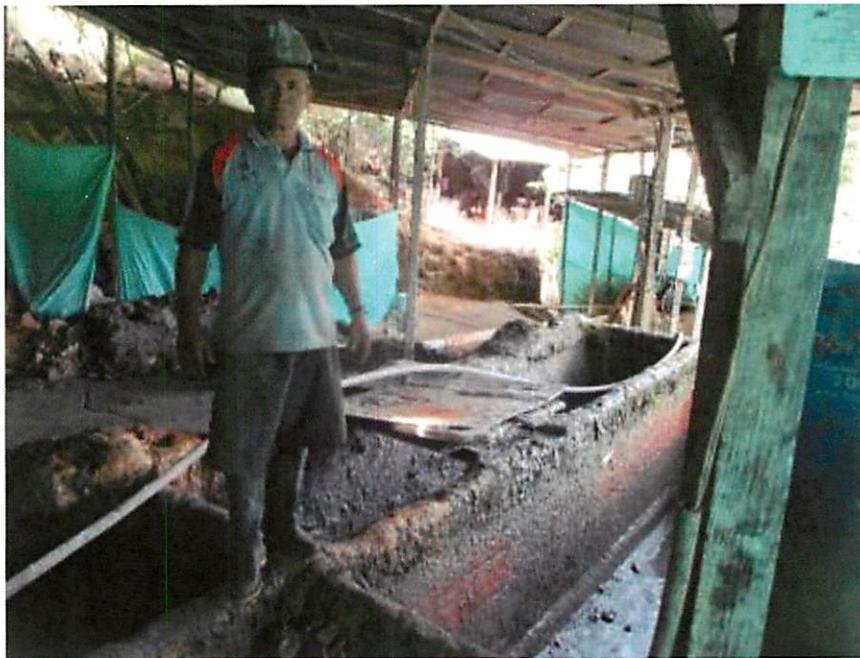
Fotografía 32. Tanques de lodos que hacen parte del proceso de cianuración.
