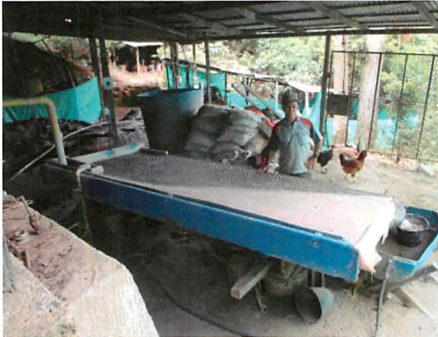
Fotografía 31. Mesa vibradora para concentración del oro libre. El mineral que queda después de sacar el oro libre es llevado al proceso de cianuración.
