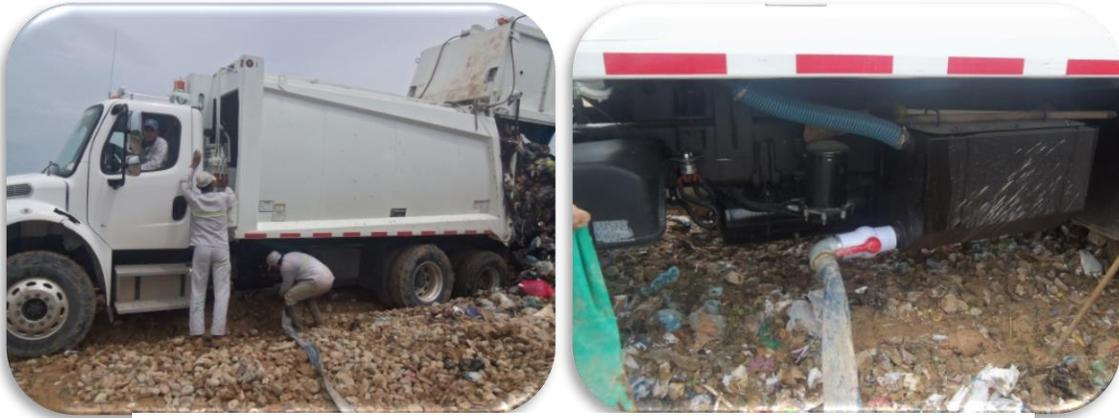
Imagen 12 y 13. Drenaje de Lixiviados de los Vehículos Compactadores.
