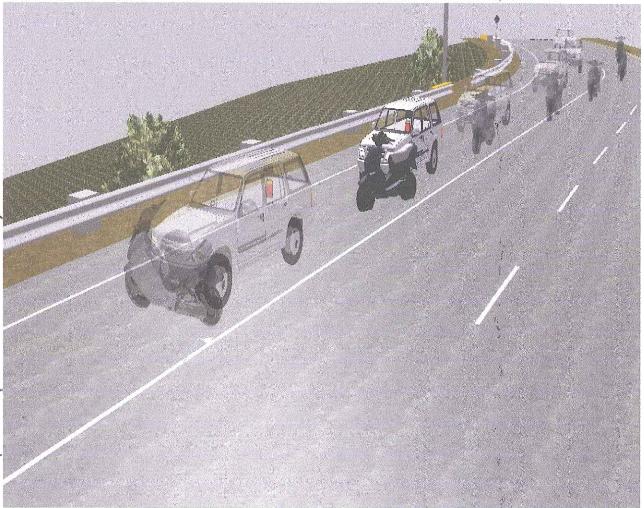
Trayectorias vehículos pre impacto, zona de invasión de carril y contacto
