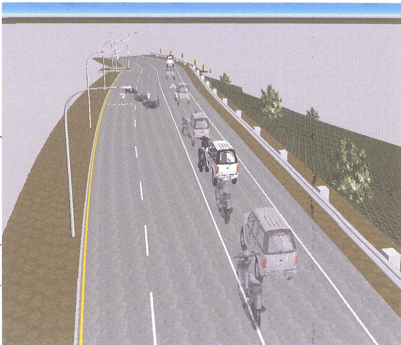
Vista posterior lugar de los hechos, registro de trayectorias pre impacto de vehículos, evidencia de inicio invasión de carril por parte del vehículo # 1
