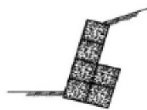
Muro de gaviones
