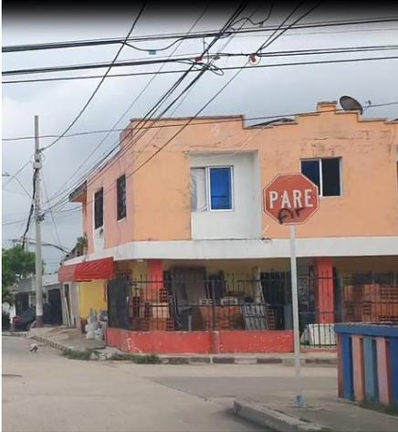
Se puede observar que existe sobre la vía de presunta trayectoria del taxi una condición para tener en cuenta y es la existencia de una muro que sobre sale en la intersección y que interfiere con la visibilidad hacia la vía de presunta trayectoria del motociclista.
