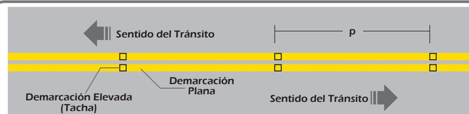
Separación vía doble sentido con restricción de adelantamiento en ambos sentidos y una separación de tachas =  $p$ , según patrón de la Tabla 3-3.
