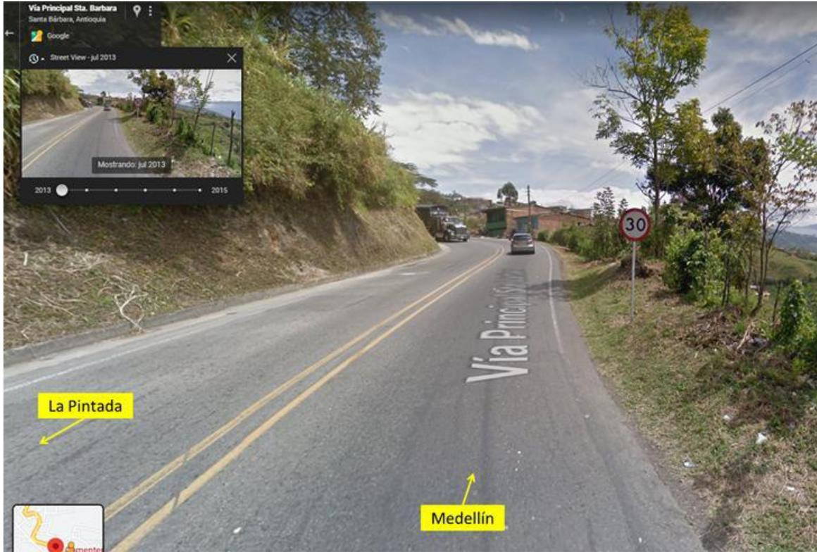
**FOTOGRAFÍA No. 3 PLANO GENERAL:** En esta fotografía tomada en sentido La Pintada – Medellín se aprecia la señal vertical SR-30 “Velocidad máxima permitida 30 km/h” más cercana al tramo de vía donde ocurrió el accidente, ubicada aproximadamente 100 metros antes del punto de referencia utilizado por la autoridad de tránsito para la elaboración del croquis. En este sentido se desplazaba el vehículo No. 2 Motocicleta.
