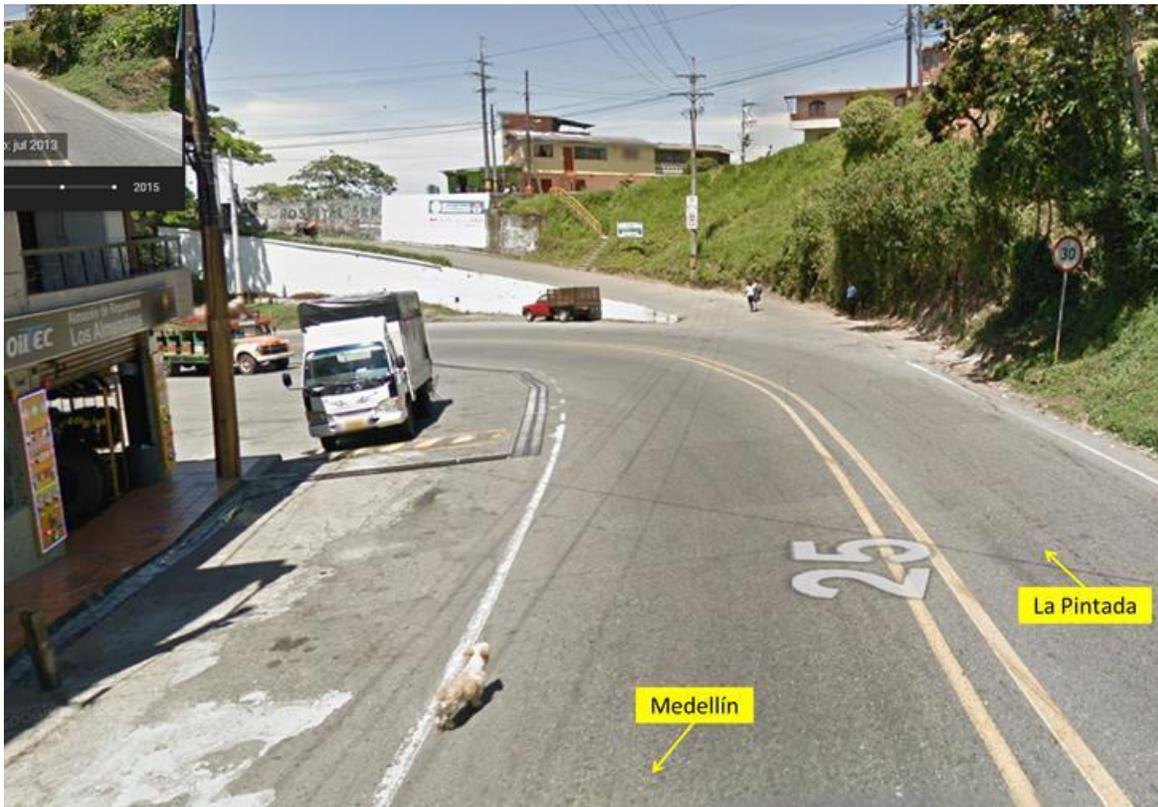
**FOTOGRAFÍA No. 1 PLANO GENERAL:** En esta fotografía tomada en sentido Medellín – La Pintada se aprecia la señal vertical SR-30 “Velocidad máxima permitida 30 km/h” más cercana al tramo de vía donde ocurrió el accidente, ubicada aproximadamente 230 metros antes del punto de referencia utilizado por la autoridad de tránsito para la elaboración del croquis. En este sentido se desplazaba el vehículo No. 1 Tractocamión.
