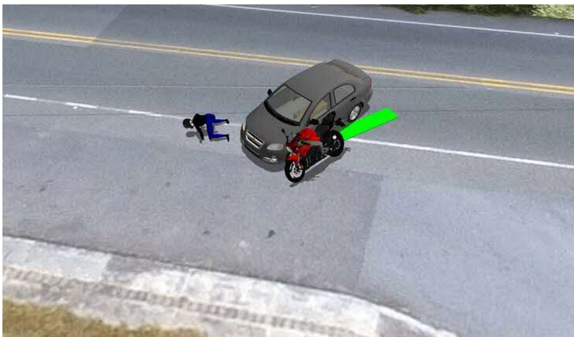
Imagen No. 23: En estas imágenes vistas en 3D se aprecia la probable secuencia del motociclista después del impacto; nótese la secuencia de la motocicleta después de la colisión.
