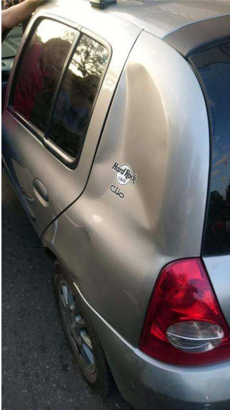
**FOTOGRAFÍA No. 9:** En esta fotografía se aprecian abolladuras en el guardafangos y nave posterior izquierda del automóvil.
