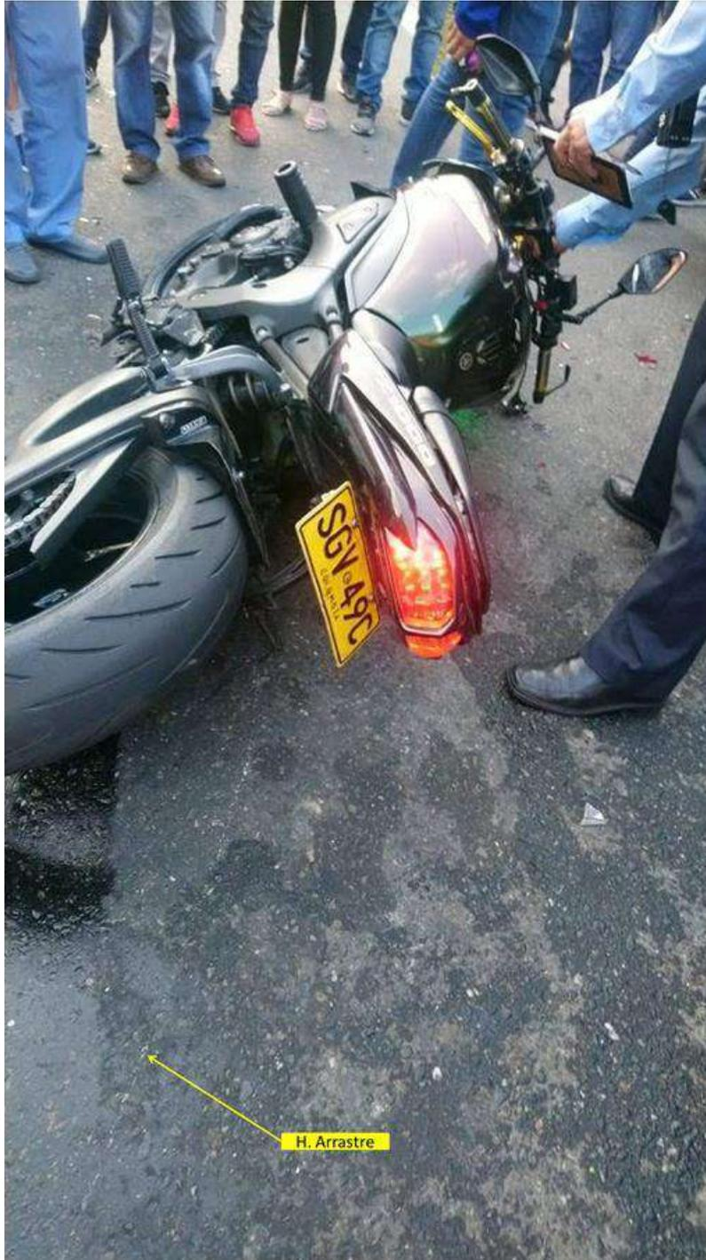
**FOTOGRAFÍA No. 11:** En esta fotografía se aprecia la posición final de la motocicleta y una huella de arrastre metálico marcada por la misma.
