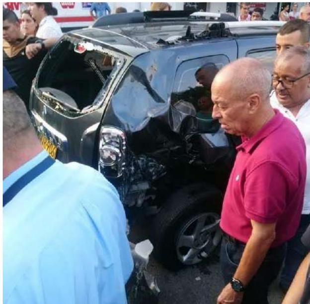
**FOTOGRAFÍAS No. 5 y 6:** En esta fotografía se aprecia el estado final de la camioneta, la cual presenta los daños en su zona posterior, y zona lateral derecha tercio posterior, afectando puerta maleta, guardafangos, nave, unidad de luz, panorámico, bomper, rueda, y soporte derecho del techo.
