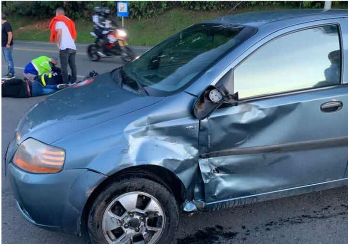
**Fotografías No. 7 y 8:** En estas fotografías se aprecian los daños en la zona lateral izquierda tercio anterior y tercio medio del automóvil, afectando bomper, rin, guardafangos, retrovisor y la puerta.
