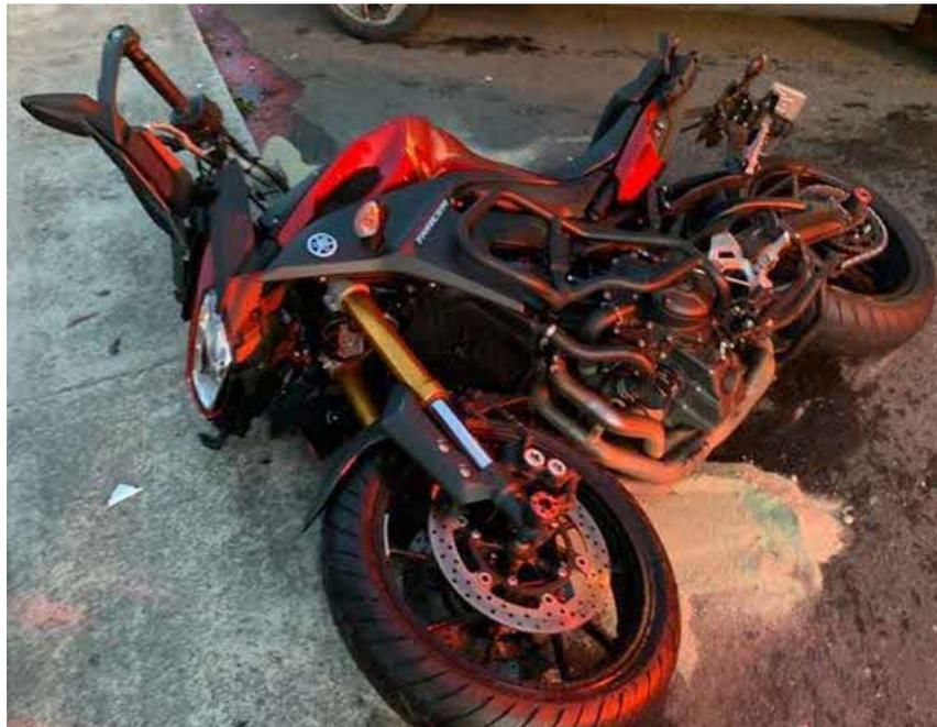
**Fotografías No. 9 y 10:** En estas fotografías se aprecia el estado final de la motocicleta, la cual presenta los daños en su zona frontal, afectando unidad de luz, carenaje, manubrio, direccionales, tacómetro, y retrovisores.
