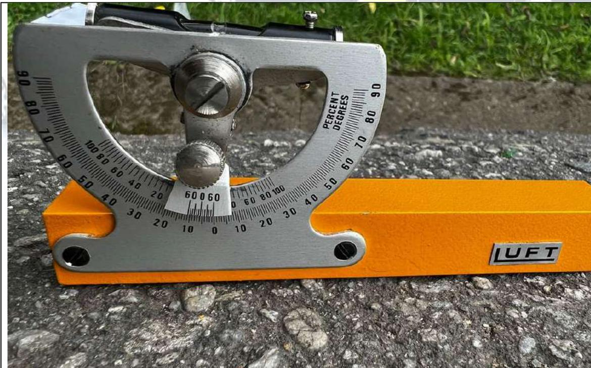
**IMAGEN No 4.** Fotografía tomada por el suscrito el día 30 de abril de 2022 en la ruta 6005 km 1+100 tramo de vía que conduce del municipio El santuario (Ant) a la ciudad de Bogotá D.C), donde se aprecia la pendiente tomada con el nivel de agme marca LUFT al frente de la señal preventiva sp-46 Peatones en la vía, dando un resultado de 6°.
