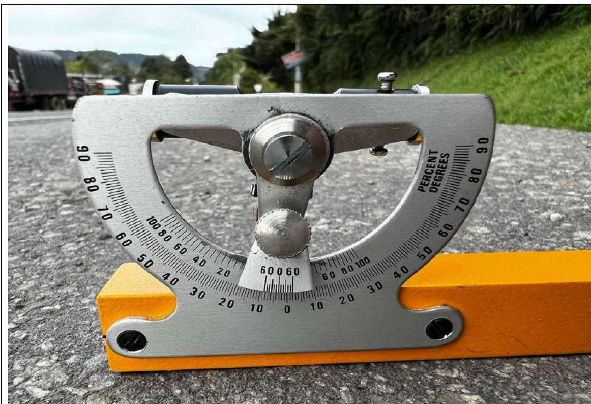
**IMAGEN No 5.** Fotografía tomada por el suscrito el día 30 de abril de 2022 en la ruta 6005 km 1+100 tramo de vía que conduce del municipio El santuario (Ant) a la ciudad de Bogotá D.C), donde se aprecia el peralte tomado con el nivel de agme marca LUFT al frente de la señal preventiva sp-46 Peatones en la vía, dando un resultado de 3°.
