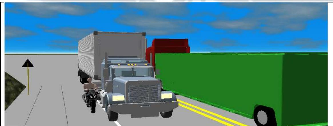
**IMAGEN No 33.** Grafica donde se aprecia con base a los EMP y EF las posiciones que tenían los vehículos involucrados en el accidente momentos antes del impacto.
