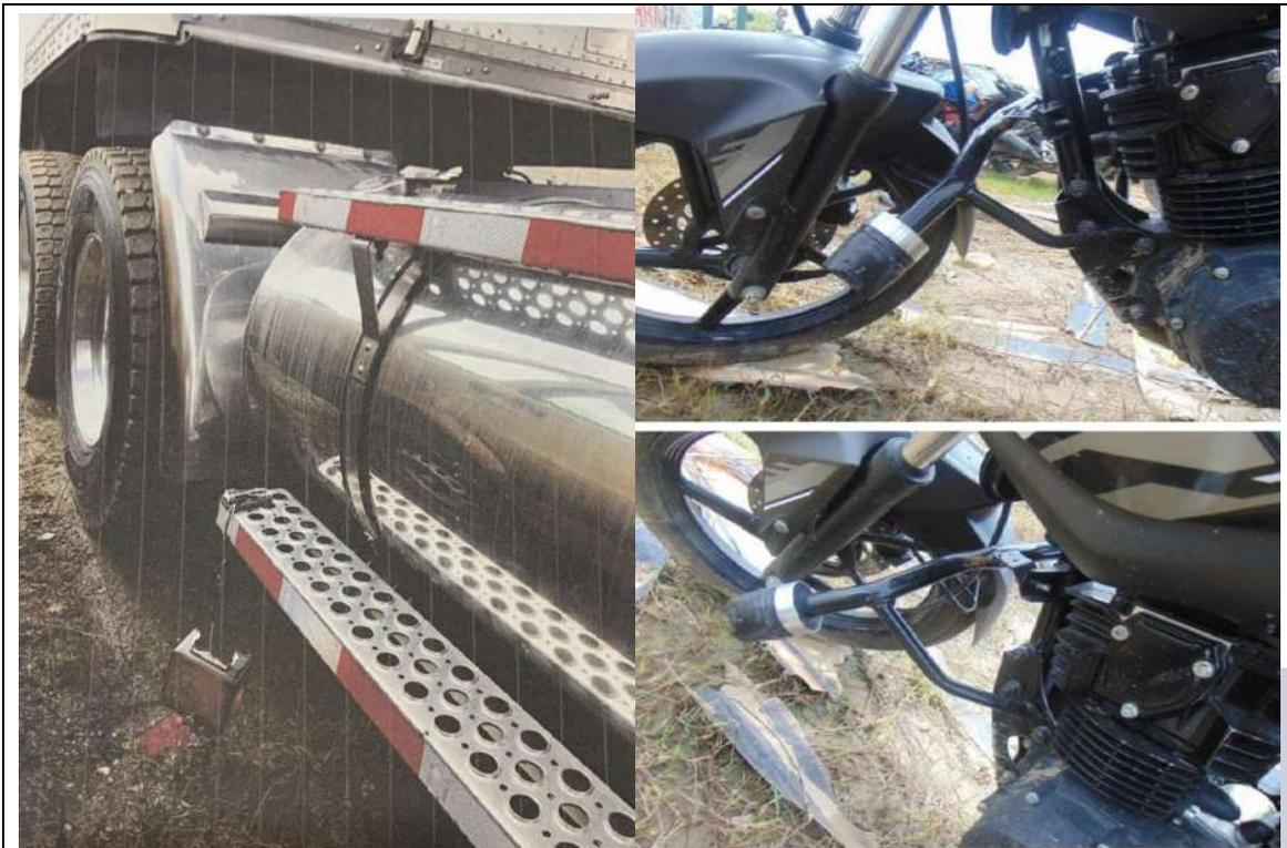
**IMAGEN No 22, 23, 24.** Fotografías aportadas a la investigación donde se demuestra con que parte del tractocamión de placas SNU-017 impacta la motocicleta de placas MSW-61E.
