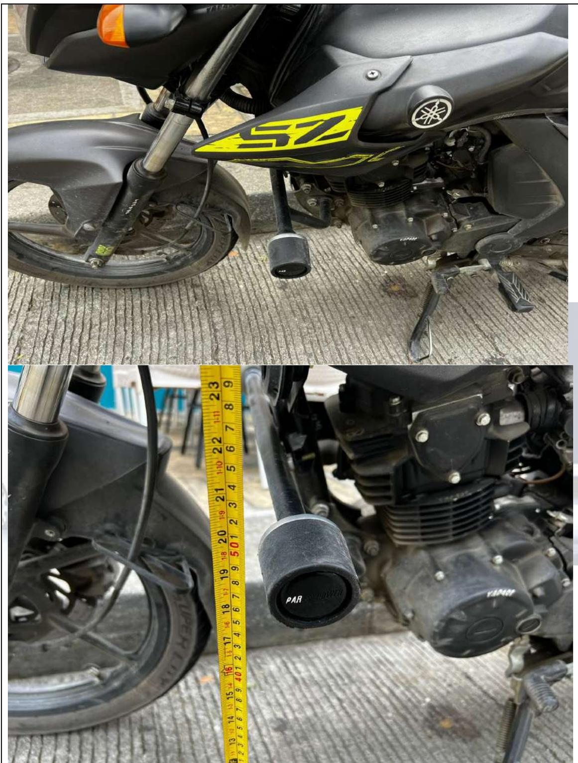
**IMAGEN No 27, 28.** Fotografía tomada por el suscrito a un vehículo motocicleta de las mismas características a la involucrada, donde se verifica la longitud del piso al slider izquierdo obteniendo una medida de 0,47 metros con la motocicleta en el gato lateral, elemento que en el accidente investigado fue desprendido con el slider de la motocicleta.
