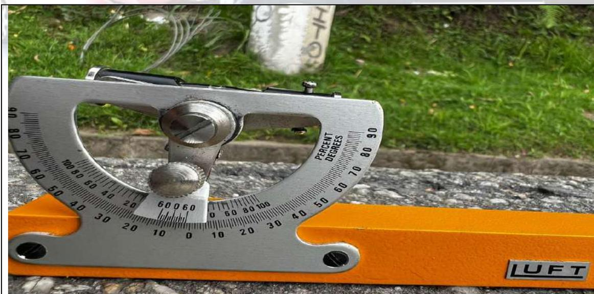
**IMAGEN No 6.** Fotografía tomada por el suscrito el día 30 de abril de 2022 en la ruta 6005 km 1+100 tramo de vía que conduce del municipio El santuario (Ant) a la ciudad de Bogotá D.C), donde se aprecia la pendiente tomada con el nivel de agme marca LUFT al frente del poste utilizado como punto de referencia, dando un resultado de 7°.
