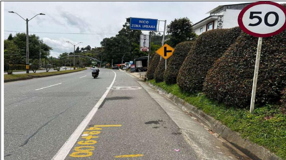
**IMAGEN No 8.** Fotografía tomada por el suscrito el día 30 de abril de 2022 en la ruta 6004 km 49+900 tramo de vía que conduce del municipio de Bello (Ant) al municipio de El santuario (Ant), donde se aprecia la señal informativa (INICIO ZONA URBANA) y la señal reglamentaria SR 30 velocidad máxima 50 km/h.
