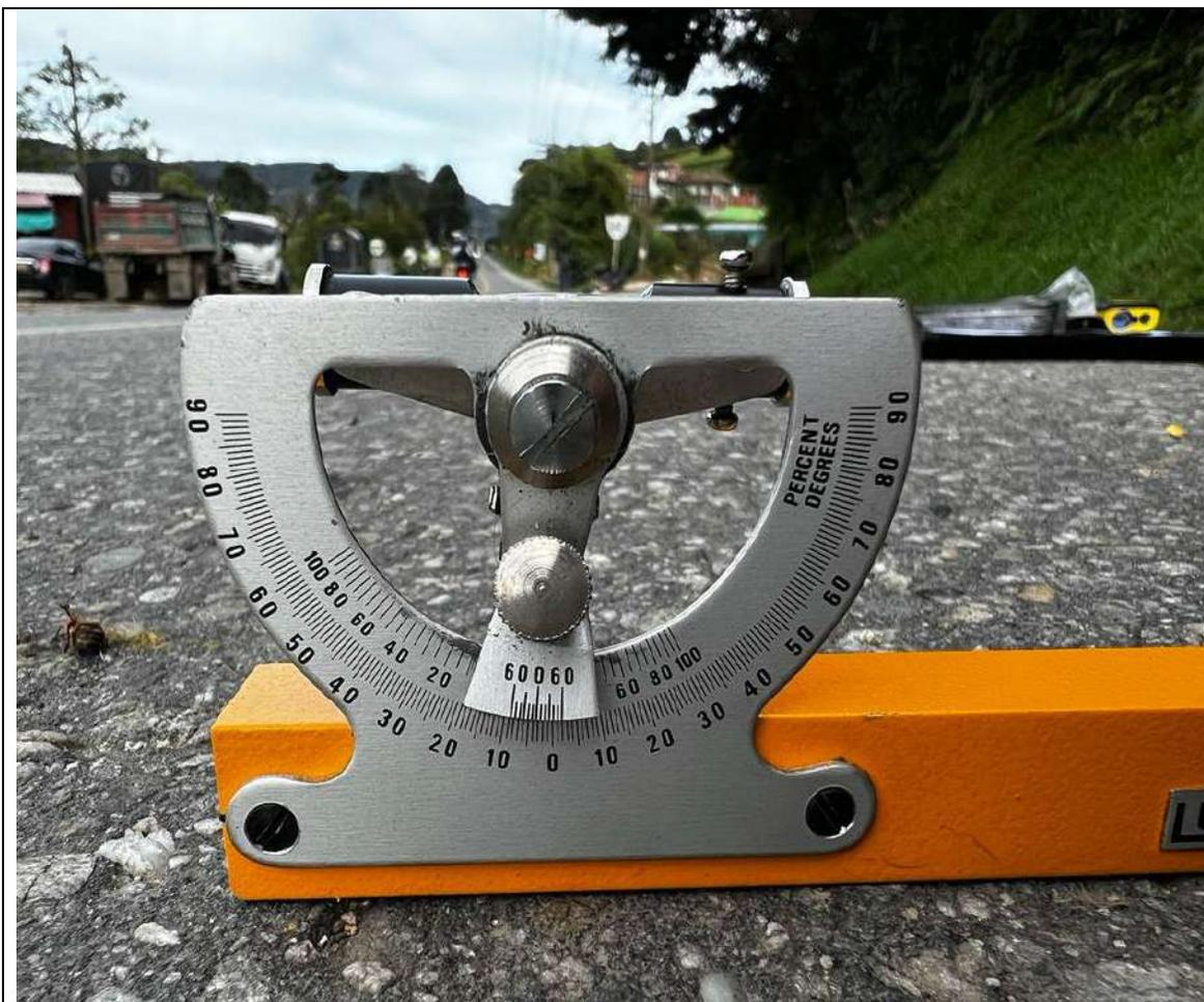
**IMAGEN No 7.** Fotografía tomada por el suscrito el día 30 de abril de 2022 en la ruta 6005 km 1+100 tramo de vía que conduce del municipio El santuario (Ant) a la ciudad de Bogotá D.C), donde se aprecia el peralte tomado con el nivel de agme marca LUFT al frente del poste utilizado como punto de referencia, dando un resultado de 3°.
