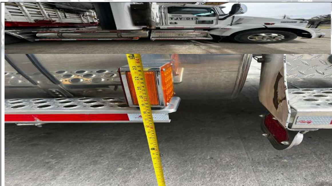
**IMAGEN No 25, 26.** Fotografía tomada por el suscrito a un vehículo tractocamión de las mismas características al involucrado, donde se verifica la longitud del piso a la luz direccional del estribo derecho del tanque de combustible obteniendo una medida de 0,50 metros, elemento que en el accidente investigado fue desprendido con el slider de la motocicleta.
