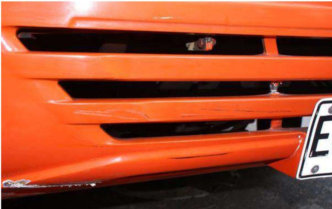
**FOTOGRAFÍAS No. 12 y 13:** En estas fotografías se aprecian rayones, tatuajes de color negro, y desprendimiento de pintura en el bomper frontal tercio izquierdo y derecho del bus.
