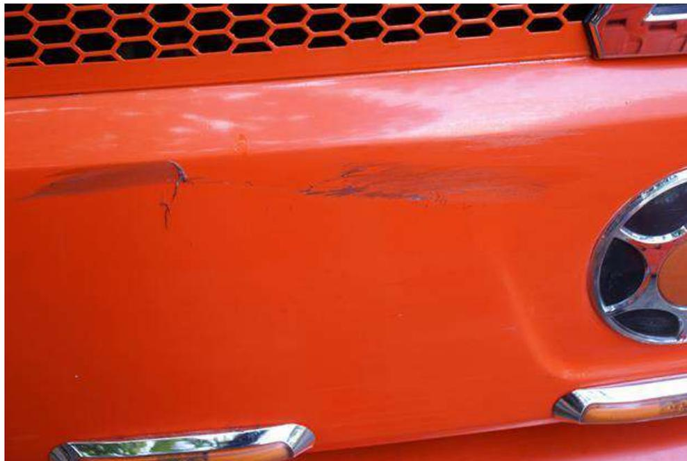
**FOTOGRAFÍAS No. 10 y 11:** En estas fotografías se aprecian residuos de plástico en la zona frontal tercio medio del bus.
