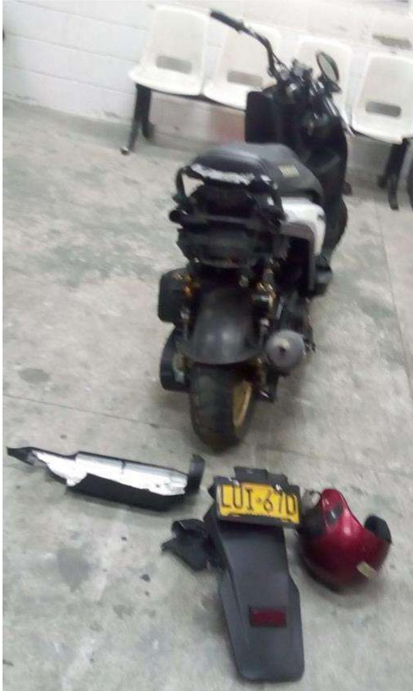
**FOTOGRAFÍA No. 4:** En esta fotografía se aprecia el estado final de la zona posterior de la motocicleta; nótese el desprendimiento del guardafangos, la placa, y el protector del mofle.
