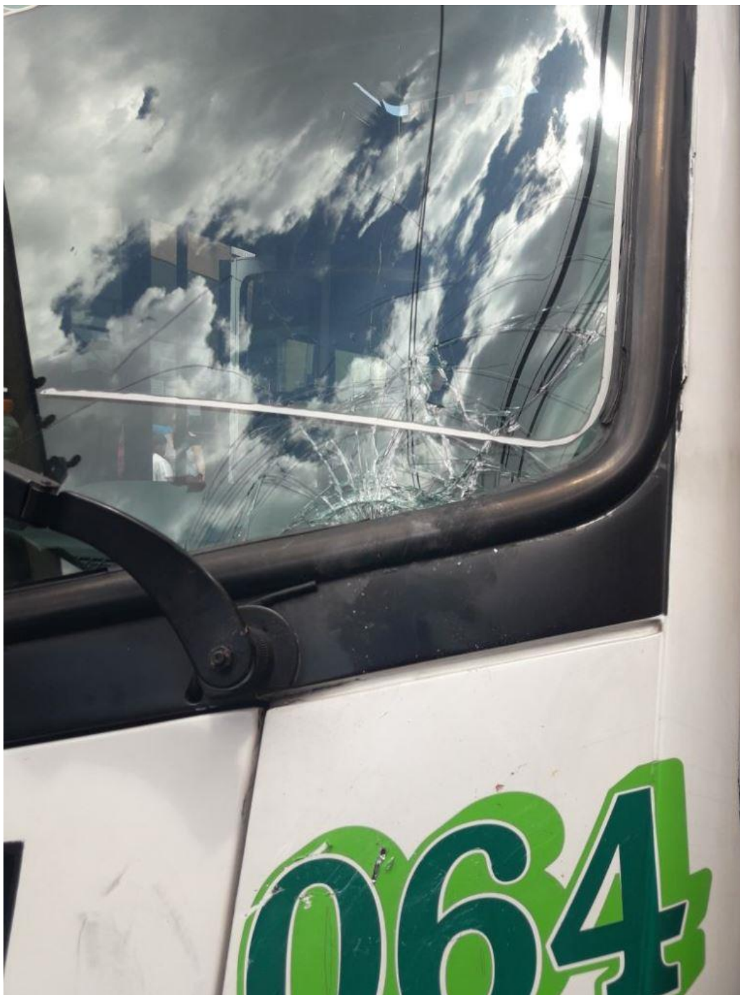
FOTOGRAFÍA No. 6: En esta fotografía se aprecia poli fragmentación en el tercio izquierdo inferior del panorámico frontal del microbús.
