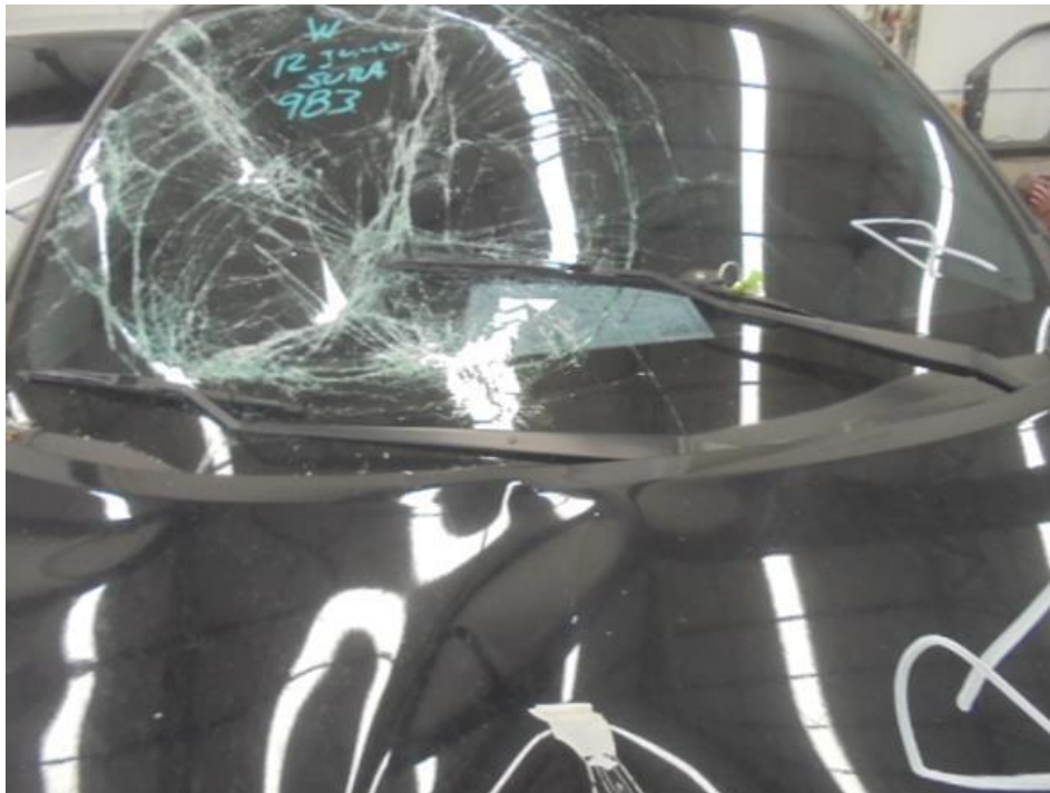
FOTOGRAFÍAS No. 7 y 8: En estas fotografías se aprecia respectivamente la deformación en el capó, y el panorámico frontal.
