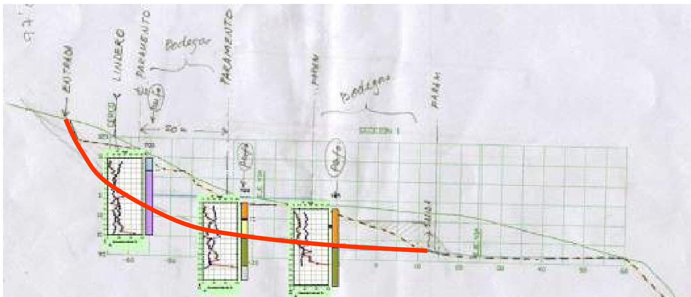
Figura 1 - Localización de la superficie de falla
