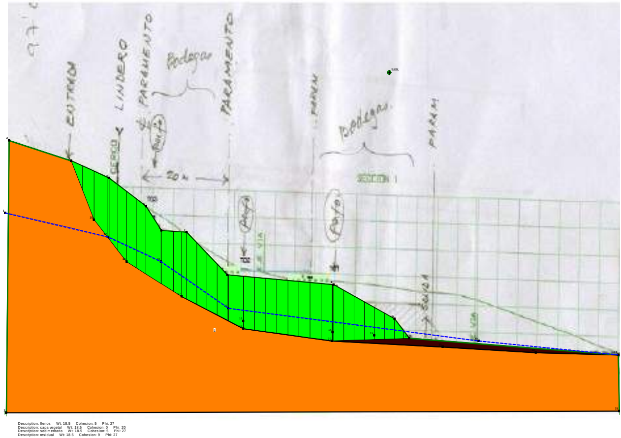
Figura 1 - Retroanálisis de falla con nivel freático, F_s=0.989 (ángulo de fricción crítico 20^\circ )
