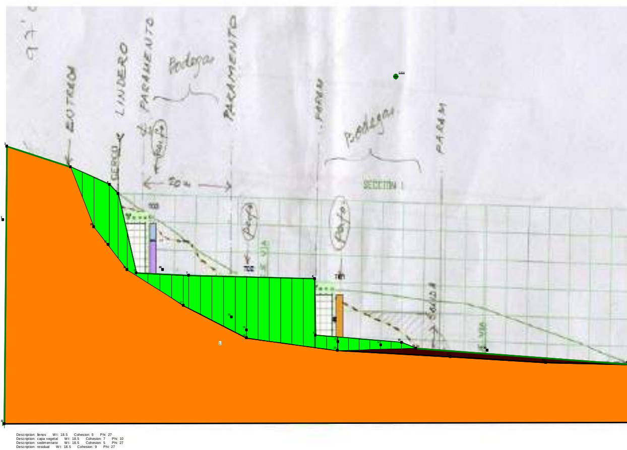
Figura 4 - Análisis de corte, F_s=0.827
