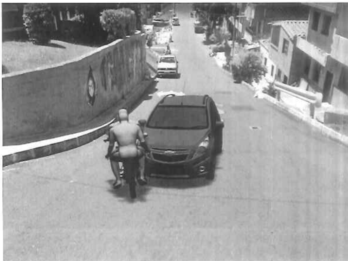
IMAGEN No. 25: En esta imagen vista en 3D se aprecia la posición relativa de los vehículos al momento del impacto.
