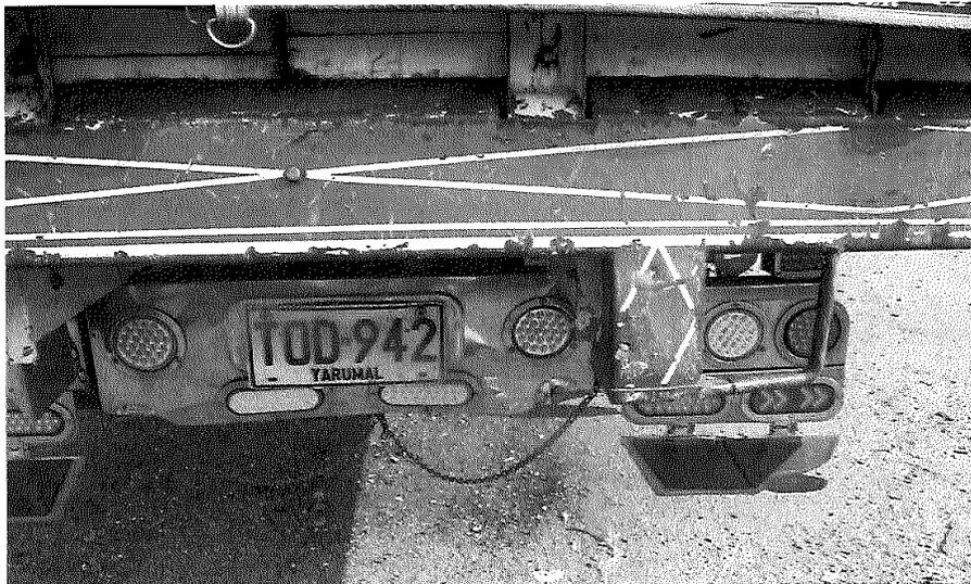
Fotografía N° IMG\_0158, PRIMER PLANO: Se observa desviación en base luces traseras y rayones fuertes.
