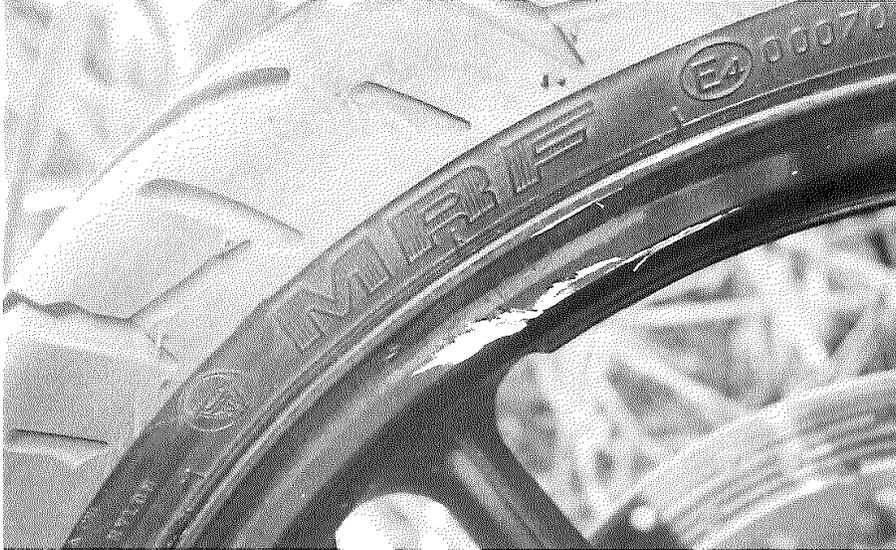
Fotografía N° IMG\_0078, PLANO MEDIO: Se observa Rayón fuerte en rin delantero.
