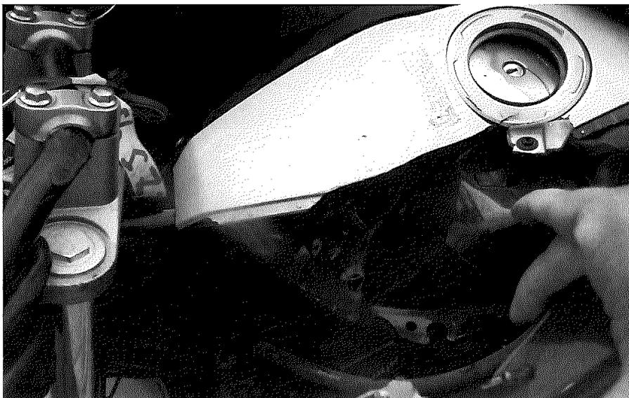
Fotografía N° IMG\_0080, **PRIMER PLANO**: Se observa fisura en carenaje de tanque.
