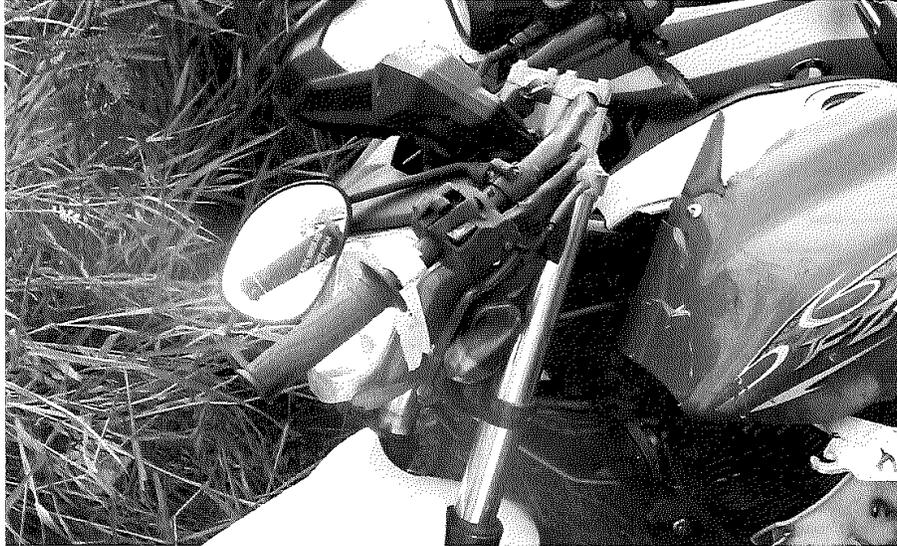
Fotografía N° IMG\_0081, **PLANO MEDIO**: Se observa manubrio en avanzado estado de destrucción.
