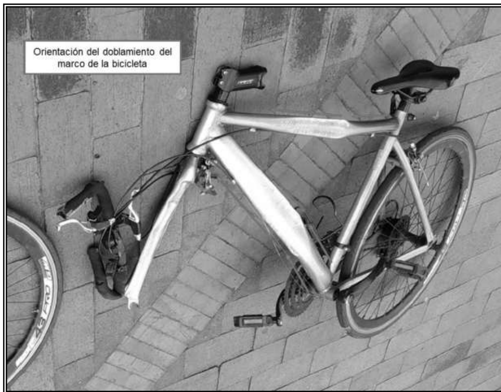
Imagen 3.10 Características del daño en marco
