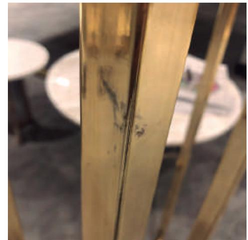
Pintura en mal estado defectos de textura, golpeada, peladuras manchada, rayada, diferentes colores en un mismo mueble.
