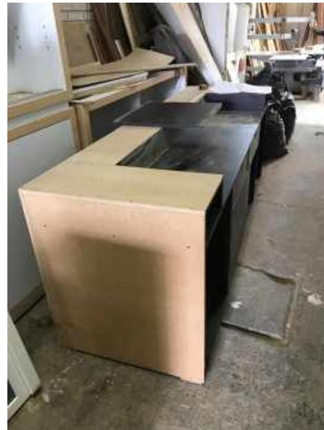
Mueble en estructura interna en mdf acabado en formica acabado color negro, acabado exterior en mármol referencia Volakas, **1/1 Und** en proceso de acabado en marmol.
