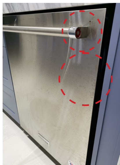
Imágen 6E ▶ Lavavajillas manchado
