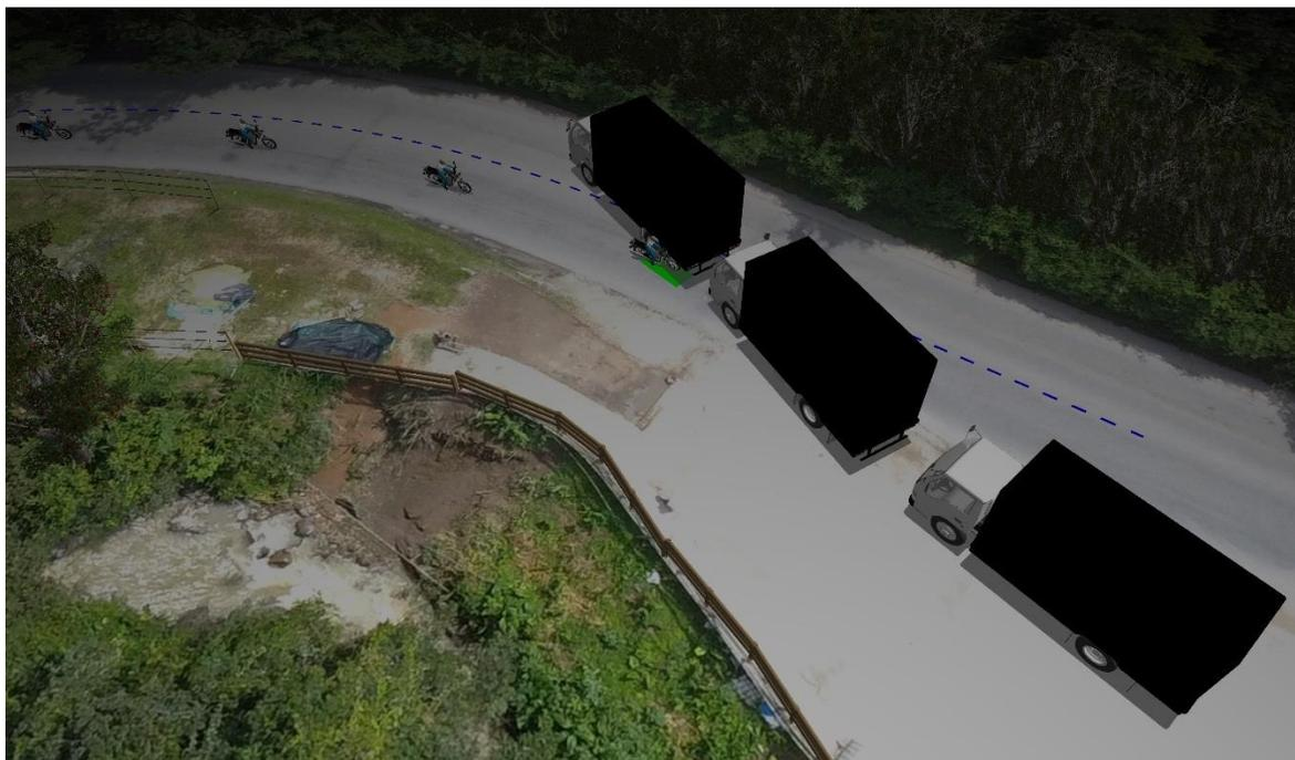
**Imagen No. 19:** En estas imágenes en 3D se aprecia la secuencia de los vehículos antes de la colisión, la posición relativa al momento del impacto, y el área de color verde donde colisionaron.
