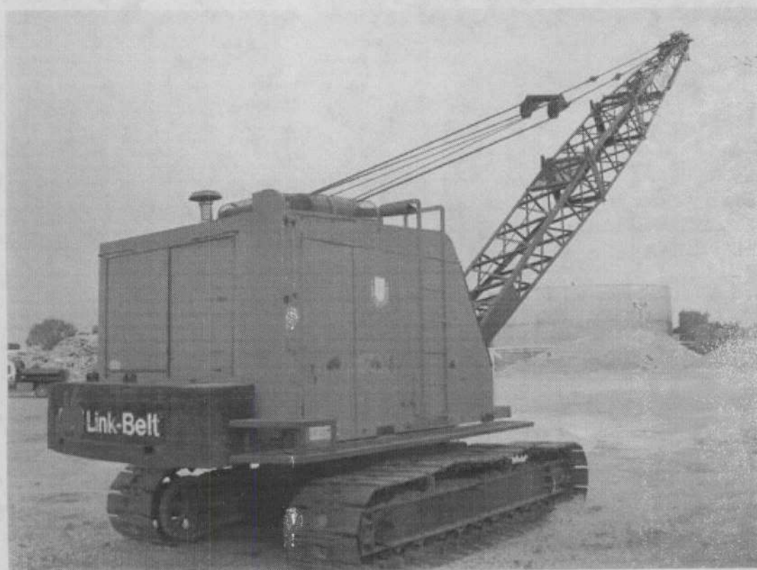
Foto tomada de internet y aportada por el perito por razones ilustrativas del tipo de grúa Link-Belt LS98
