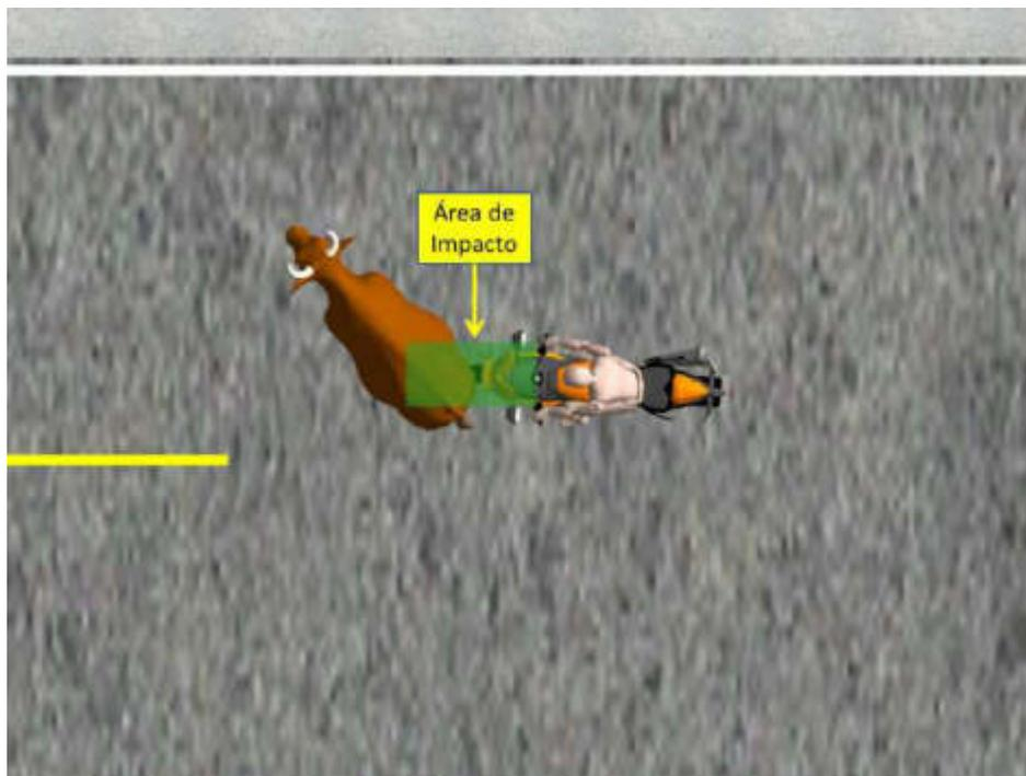
**IMAGEN No. 14:** En esta imagen se muestra la posición relativa del vehículo al momento del impacto con el semoviente si éste último se desplaza de izquierda a derecha.
