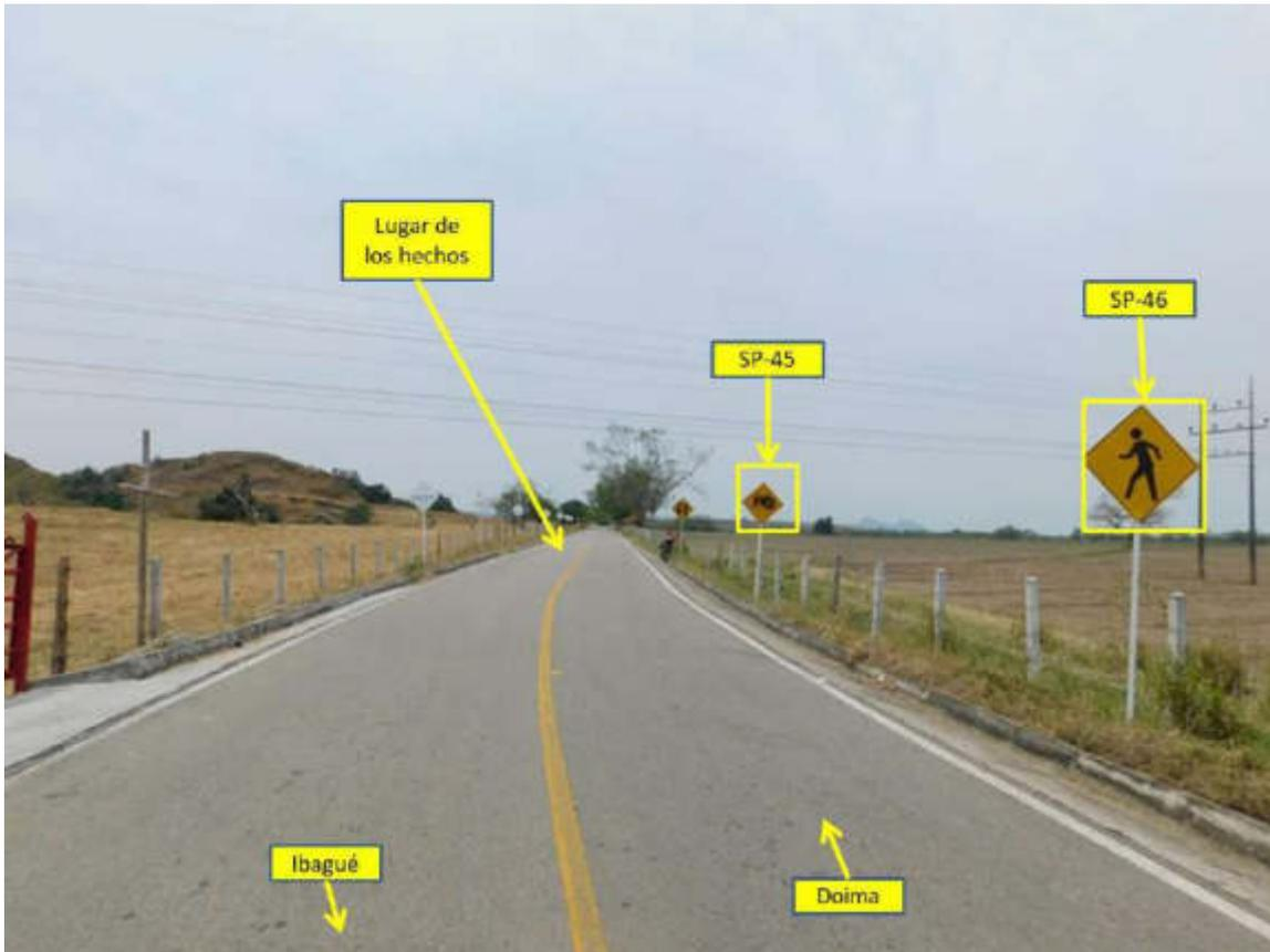
**FOTOGRAFÍA No. 7 PANORÁMICA:** En esta fotografía tomada por el equipo de IRS Vial en sentido Ibagué - Doima a la altura del km 0 + 030 m, se aprecian las características generales de la vía, en la cual se encuentra demarcación horizontal de línea amarilla continua y líneas de borde, con señalización vertical SP-46 “Peatones en la vía” y SP-45 “Maquinaria agrícola en la vía”.
