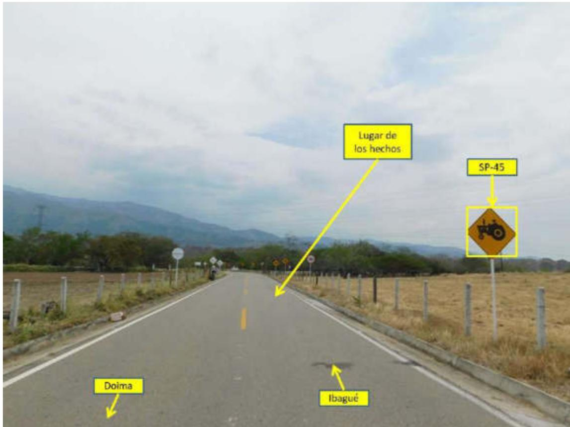
**FOTOGRAFÍA No. 5 PANORÁMICA:** En esta fotografía tomada por el equipo de IRS Vial en sentido Doima – Ibagué a la altura del km 0 + 100 m, se aprecian las características generales de la vía, en la cual se encuentra demarcación horizontal de línea amarilla segmentada y líneas de borde, con señalización vertical SP-45 “Maquinaria agrícola en la vía”; en este sentido se desplazaba el vehículo No. 1 (Motocicleta).
