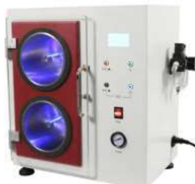
Ilustración 1. Probador de formación de motas de rotación aleatoria (Random Tumble Pilling Tester)
