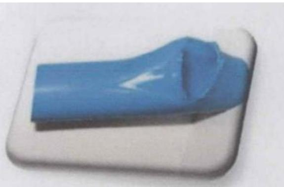
Fotografía No. 2 Muestra de tubería de polipropileno PN 10 rota por exceso de temperatura
