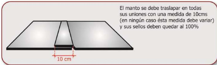
Una vez ubicado y presentado el primer rollo se debe re enrollar hasta la mitad para iniciar de un lado y luego al otro. De esta forma se evitará que se desplace y se desalineen los traslapos.
