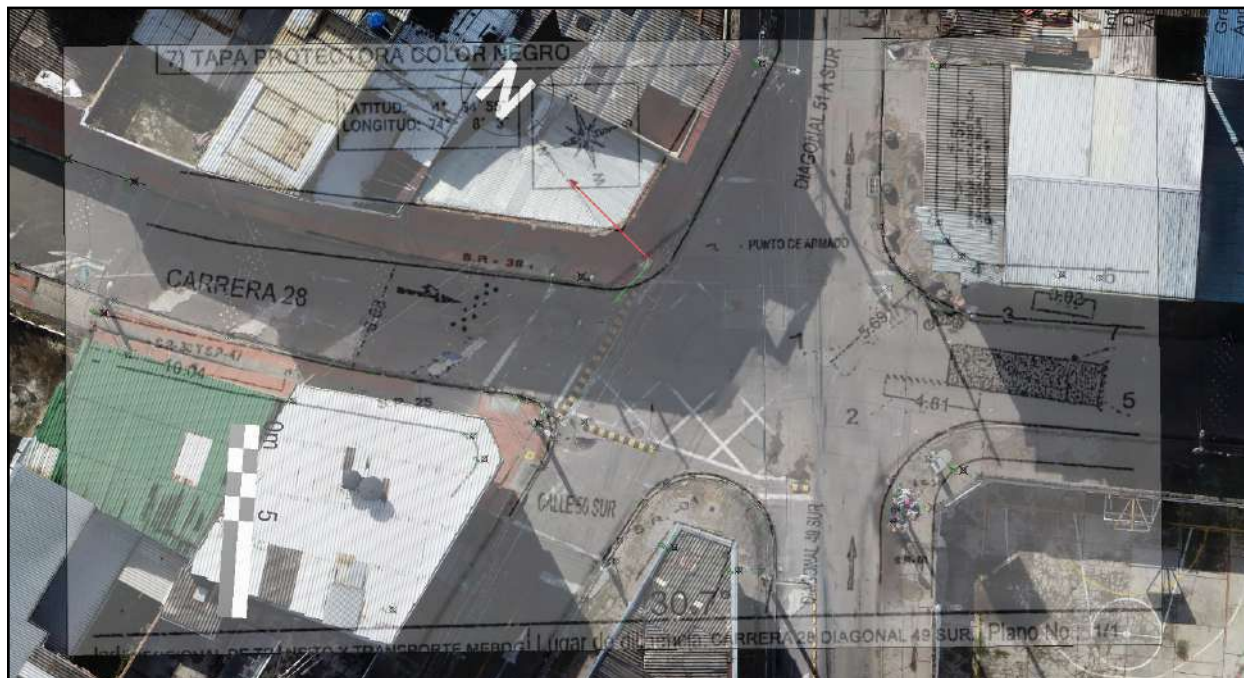
Imagen 24. Sobreexposición del plano topográfico elaborado por la autoridad de tránsito en relación con el ortomosaico elaborado a partir de fotografía aérea.
