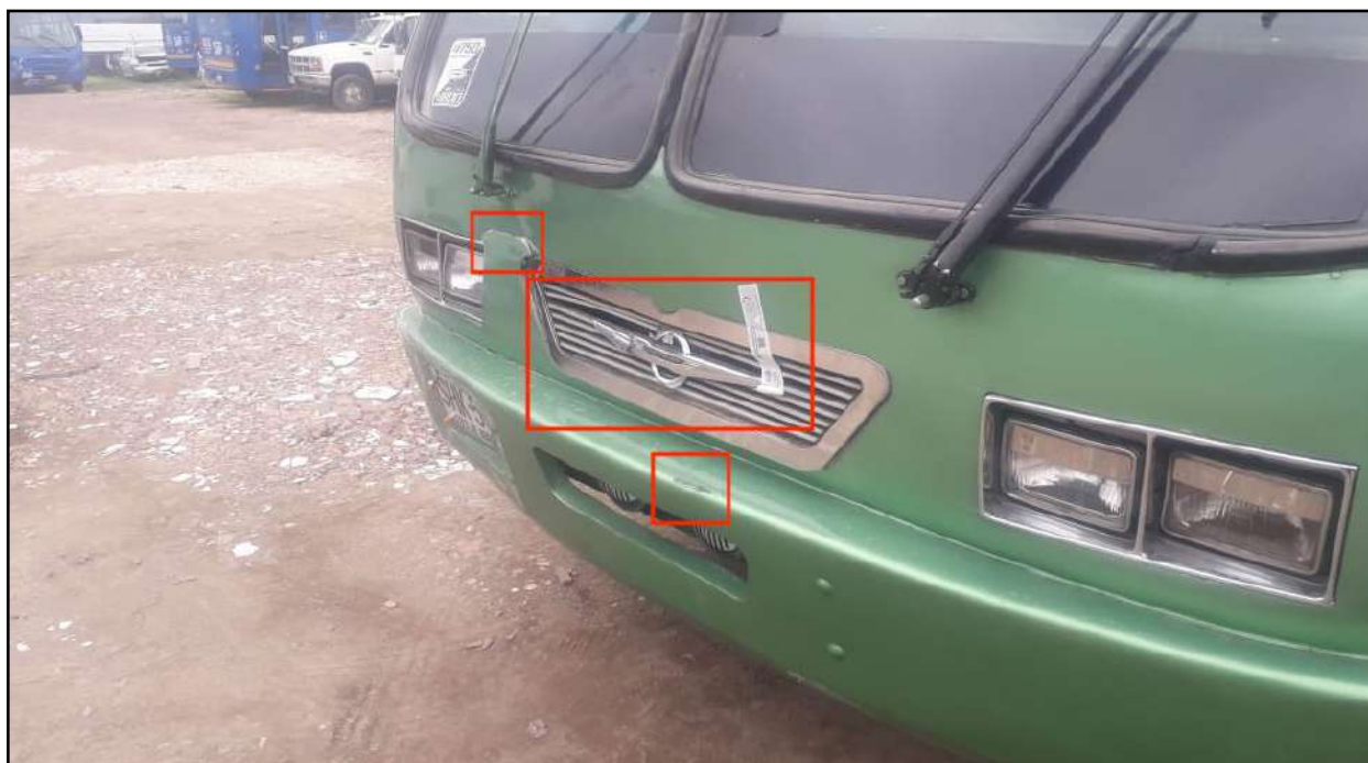
Imagen 30. Primer plano del vehículo (1) buseta parte frontal lado izquierdo, se observa ruptura y abolladura en tercio medio y derecho de persiana frontal, marca de abrasión con pérdida de pintura en defensa anterior tercio medio.
