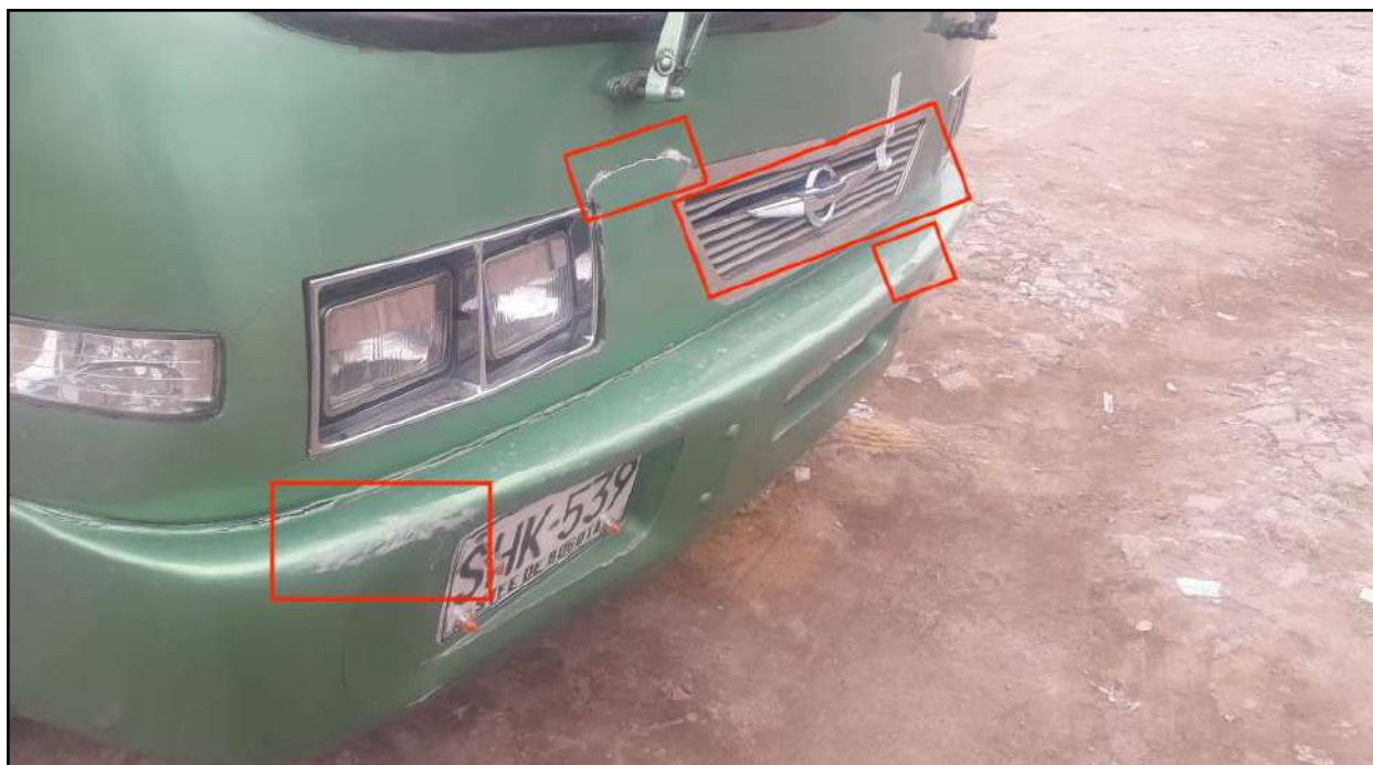
Imagen 29. Primer plano del vehículo (1) buseta parte frontal y lado derecho, se observa ruptura y abolladura en tercio medio y derecho de persiana frontal, marcas de abrasión con pérdida de pintura en defensa anterior tercio derecho y marca de abrasión con pérdida de pintura en defensa anterior tercio medio.
