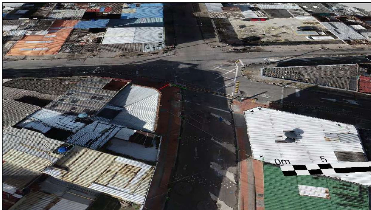
Imagen 4. Procesamiento de información topográfica y ortomosaico obtenida por fotogrametría y fotografía aérea, para reconstrucción en tres dimensiones de la vía objeto de análisis.
