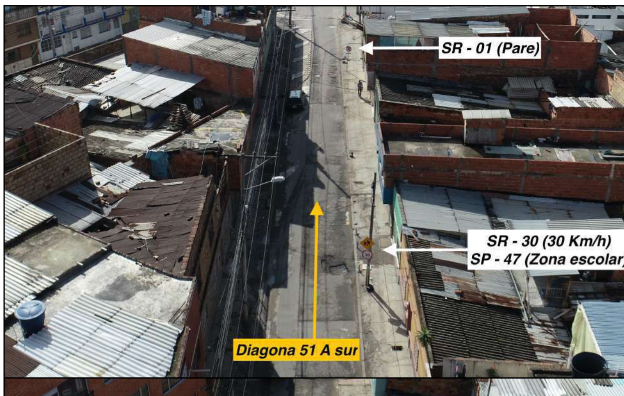
Imagen 12. Panorámica de la Diagonal 51 A sur norte a sur, vía por donde circulaba el vehículo (2) motocicleta se observa señalización vertical y horizontal.
