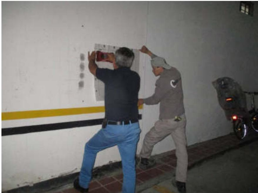
Figura 13– Lecturas de ferroskan para establecer el reforzamiento del muro
