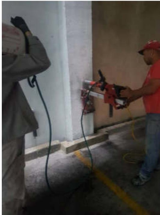
Figura 20 – Extracción de núcleo en columna.
