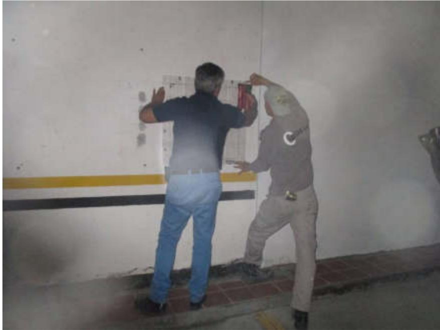
Figura 12– Lecturas de ferroskan para establecer el reforzamiento del muro
