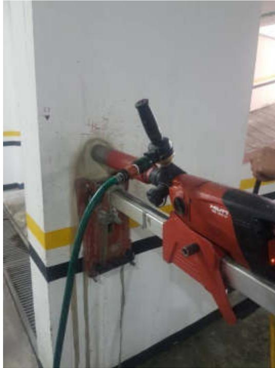
Figura 22– Extracción de núcleo en pantalla.
