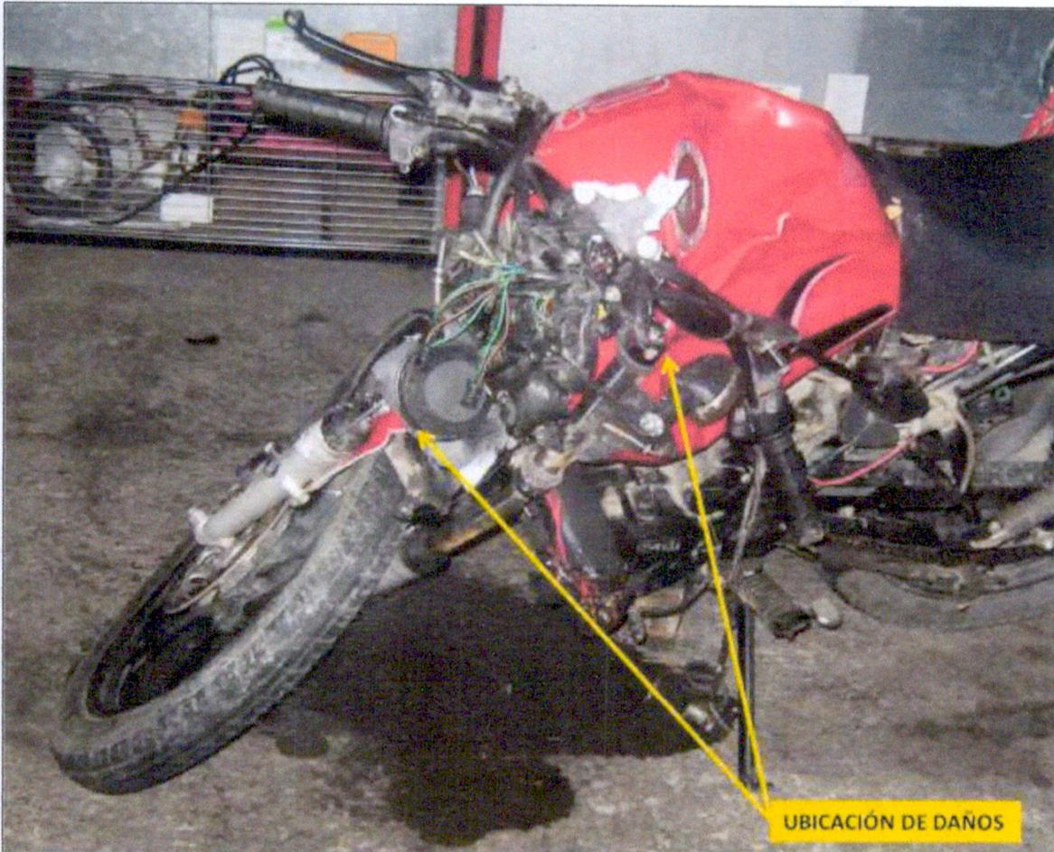
**FOTOGRAFÍA No 04: PRIMER PLANO** En esta fotografía se observa con más detalle los daños en la zona anterior del vehículo, los cuales corresponden a destrucción total de su estructura.
