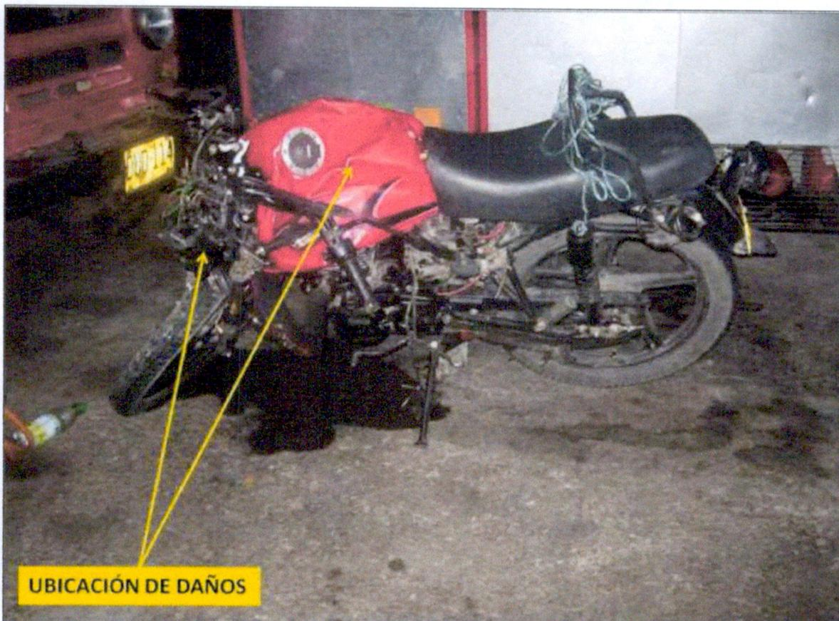
**FOTOGRAFÍA No 03: PRIMER PLANO** En esta fotografía se observan los daños que presentó el vehículo tipo motocicleta, los cuales corresponde a destrucción de su zona anterior y múltiples abolladuras a la altura del depósito de combustible.
