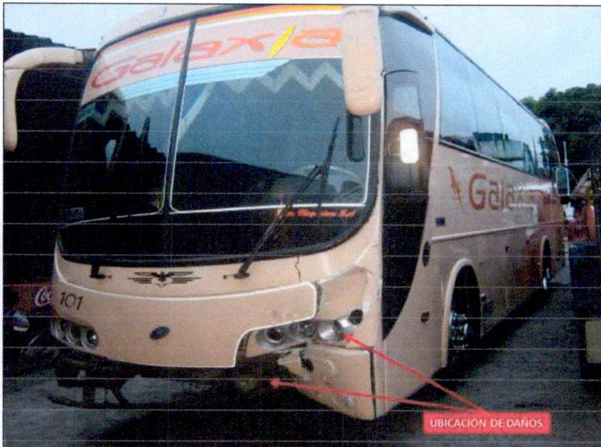
**FOTOGRAFÍA No 05: PRIMER PLANO** En esta fotografía se observan los daños que presentó el vehículo tipo bus en su zona anterior (tercio izquierdo), los cuales corresponde a desprendimiento y deformación del paragolpes, múltiples rupturas del vértice izquierdo, fragmentación del vidrio panorámico y destrucción de la unidad de luz izquierda.
