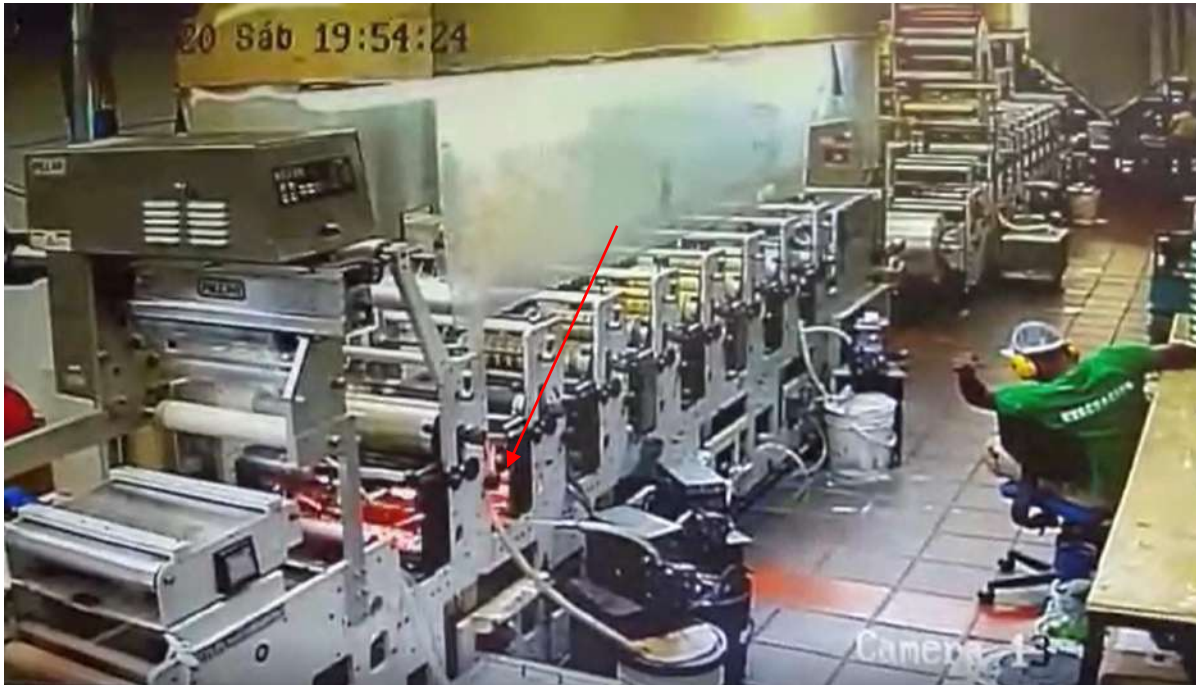
Se señala el lugar del origen del incendio en la máquina impresora No 2.
