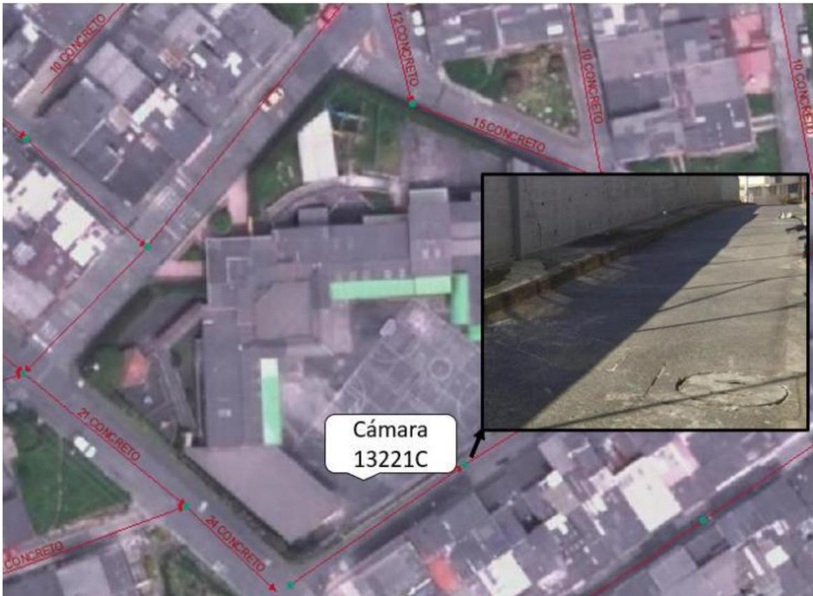
De igual manera, para identificar el punto de entrega de las aguas lluvias, se procedió a aplicar color mineral, y se encontró que el canal lateral de la cancha de microfútbol que recoge las aguas lluvias, entrega estas aguas a través de dos tuberías de 3" a la cámara con ID 13221C que es la misma donde se entregan las aguas residuales, tal como se muestra en la imagen 6.
