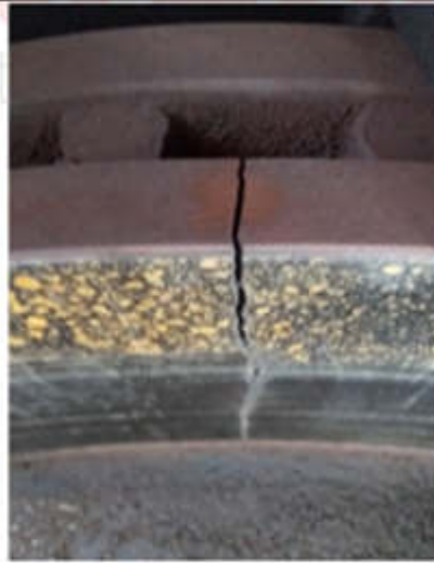
FRACTURA DISCOS DE FRENO POSICION 1
