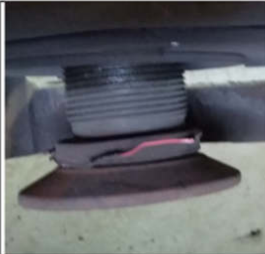
DANO EN ORINGS Y GUARDAPOLVOS DE PISTONES MORDAZA POR ALTA TEMPERATURA
