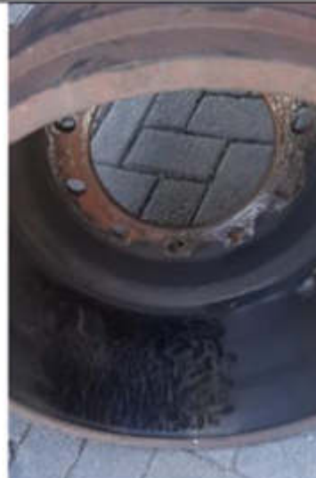
CAMPANAS PRESENTAN DEFORMACION Y CRISTALIZACION POR TEMPERATURA
