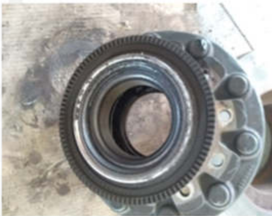
RETENEDORES DE CUBOS DE RUEDA DELANTEROS QUEMADOS POR ALTA TEMPERATURA
