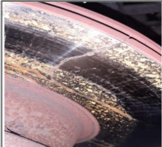
DISCOS DE FRENO FRACTURADOS POR CHOQUE TERMICO (CAMBIO BRUSCO DE TEMPERATURA)
