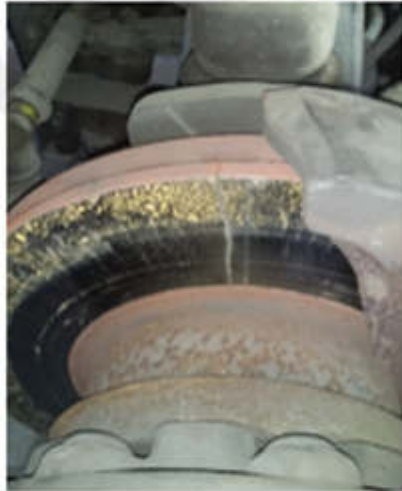
EVIDENCIA DE DISCO FRENOS RUEDA DERECHA FRACTURADO (POSICION 1)
