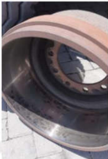
CAMPANAS PRESENTAN DEFORMACION Y NO PERMITE UN FRENADO CORRECTO
