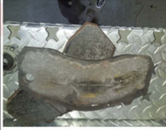
DESGASTE EXCESIVO Y PREMATURO DE PASTILLAS
