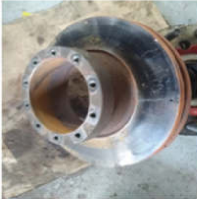
DISCO RUEDA IZQUIERDA FRACTURADO (POSICION 2)
