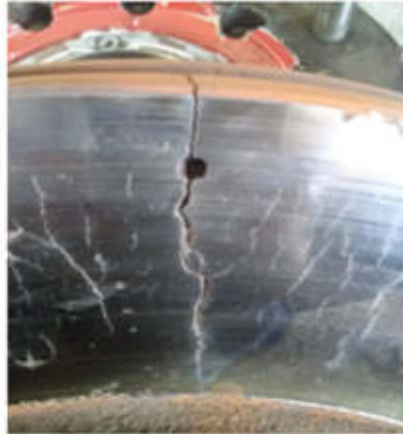
FRACTURA DISCOS DE FRENO POSICION 2
