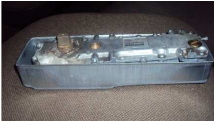
FOTO No. 3.- Vista lateral de la bisagra hidráulica sevox Modelo minus
