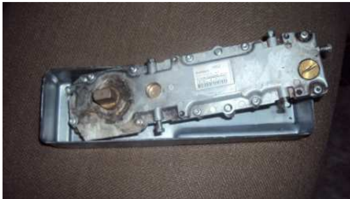
FOTO No. 2.- Base y bisagra hidráulica sevox modelo minus
