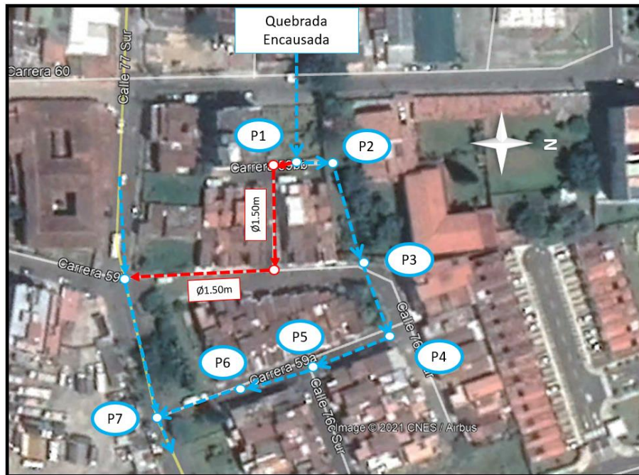
Imagen 9. Planta general Propuesta Aliviadero – Ø 1.50 m.
