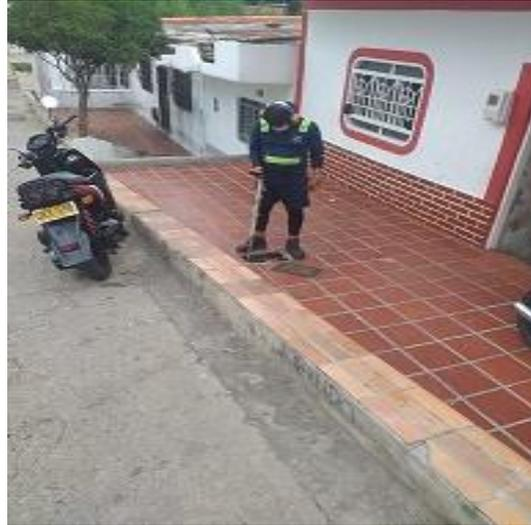
Foto 2. Geofonía punto a punto en las acometidas para descartar fugas imperceptibles.
