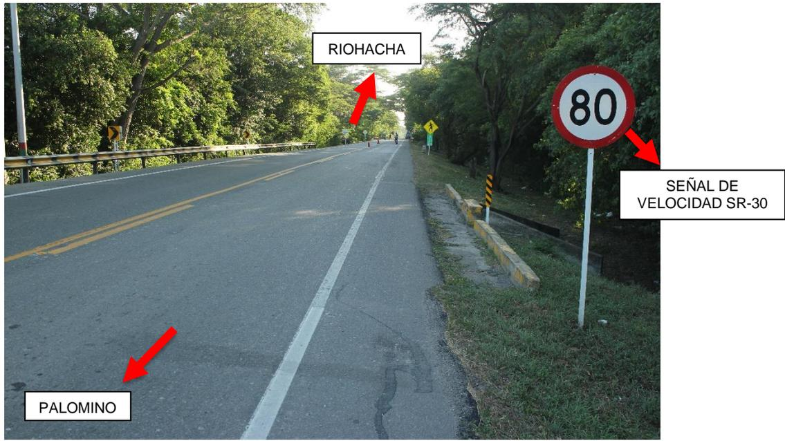
**IMG\_3652.JPG**, la imagen ilustra las características de la vía Palomino Riohacha, se evidencia una Señal Reglamentaria SR-30 que indica una velocidad para el sector de 80 km/h, la cual se encuentra ubicada a la altura del km 53+075, sentido vehicular Riohacha Palomino.
